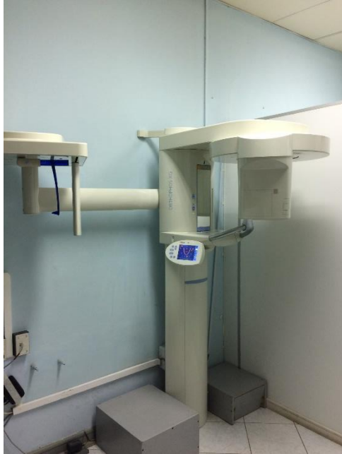
Figura n°8. Equipo de TCHC Sirona ORTHOPHOS XG DS/Ceph en instalaciones del departamento de Imagenología Oral y Maxilofacial de la Universidad de Talca. A la derecha se observa la plataforma confeccionada para la ubicación de las muestras dentro del FOV del equipo.
