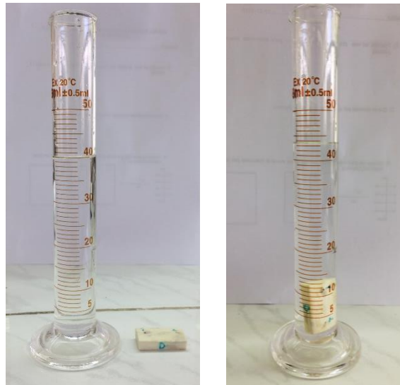
Figura n°13. Imágenes del análisis manual de volumen mediante el desplazamiento de agua de un volumen conocido de las muestras óseas. Se utilizó una probeta milimetrada de 50mm 3 .
