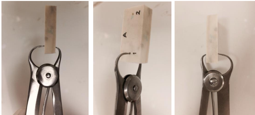
Figura n°12. Determinación manual del espesor de cada bloque óseo utilizando un calibrador de metales milimetrado.
