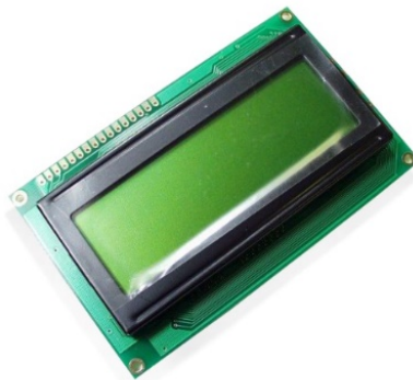
Figura 40: Pantalla LCD de 20x4 caracteres, prototipo 3.
