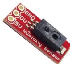
Figura 23: Sensor de humedad HIH4030 encargado de medir la humedad fuera de los invernaderos, prototipo 2.
