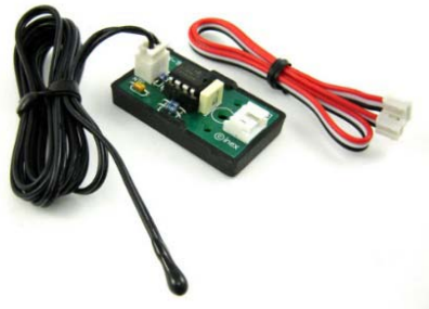
Figura 12: Sensor ZX-Thermometer encargado de medir la temperatura dentro de los invernaderos, prototipo 1.
