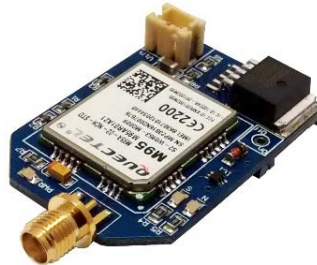
Figura 38: Módulo GPRSBee encargado del envío de las alertas tempranas, prototipo 3.
