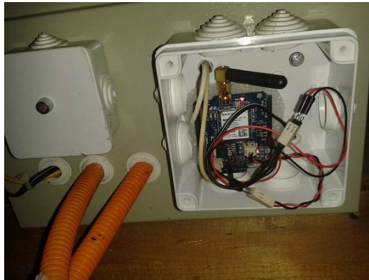
Figura 51: Posicionamiento de los sensores externos (izquierda) y GPRSbee (derecha), prototipo 3.
