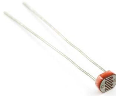
Figura 10: Sensor LDR encargado de la percepción de la luz, prototipo 1.
