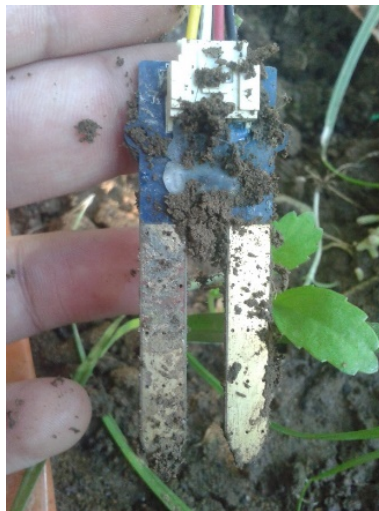
Figura 112: Corrosión del sensor SEN92355P.
