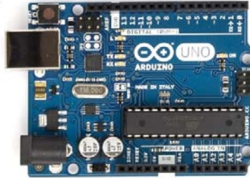
Figura 14: Arduino Uno R3, núcleo central del prototipo 1.
