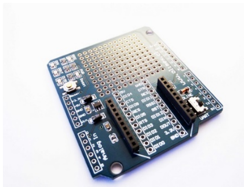
Figura 39: Xbee Shield, encargado de establecer la comunicación entre el módulo GSM y la placa Arduino, prototipo 3.
