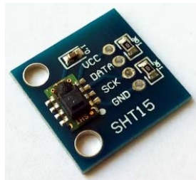
Figura 22: Sensor SHT15 encargado de medir las condiciones internas de temperatura y humedad, prototipo 2.
