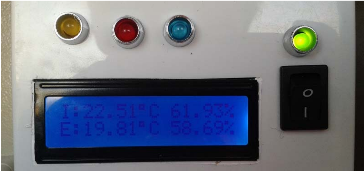
Figura 34: Panel LED (superior) y pantalla LCD (inferior), prototipo 2.
