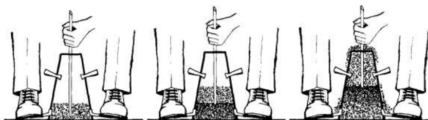
Ilustración 25: Llenado del cono en tres capas.
