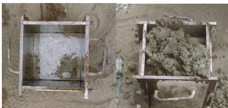
Ilustración 20: Molde con desmoldante, y posteriormente llenado.
