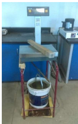
Ilustración 40: Grava saturada en agua.
