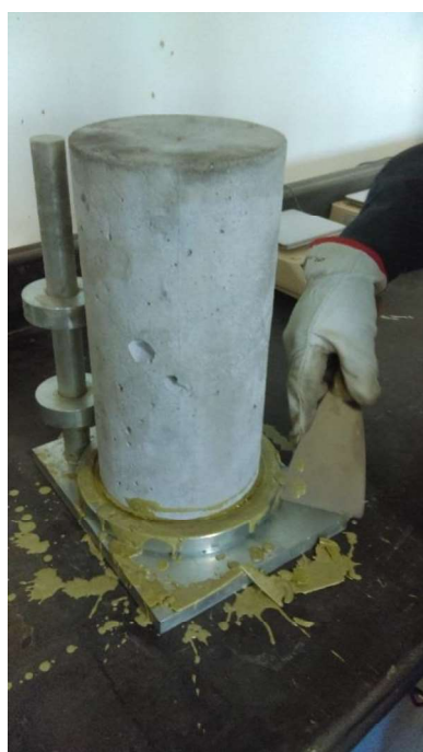
Ilustración 53: Probeta en aparato alineador. Fuente: Elaboración propia.
