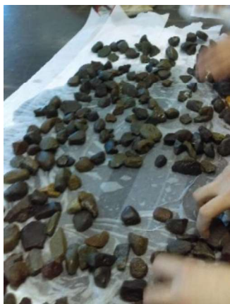
Ilustración 42: Grava superficialmente seca.
