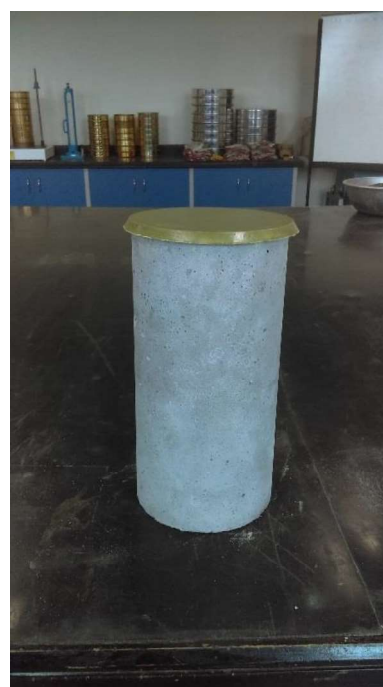
Ilustración 54: Probeta con refrentado. Fuente: Elaboración propia.
