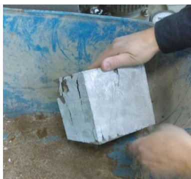
Ilustración 59: Fisuración de probeta cúbica. Fuente: Elaboración propia.
