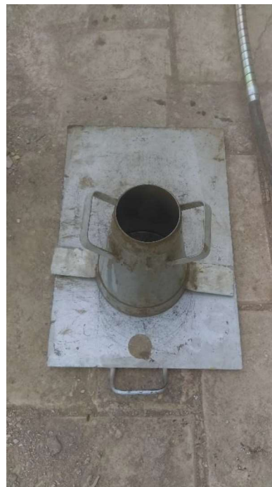
Ilustración 48: Placa base y cono humectados. Fuente: Elaboración propia.
