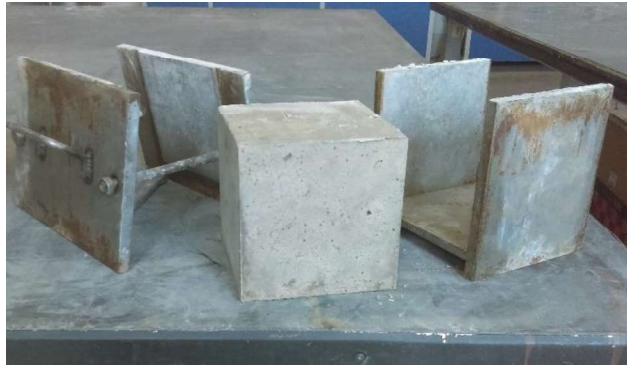
Ilustración 23: Descimbre de probetas.
