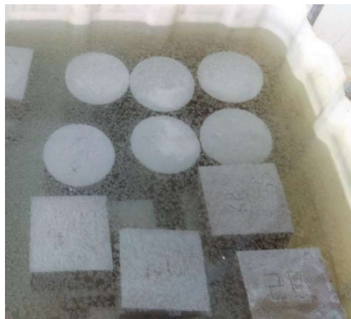
Ilustración 24: Piscina de curado con agua saturada en cal.
