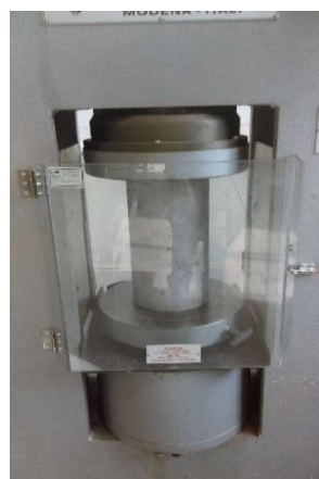
Ilustración 58: Probeta cilíndrica en prensa. Fuente: Elaboración propia.
