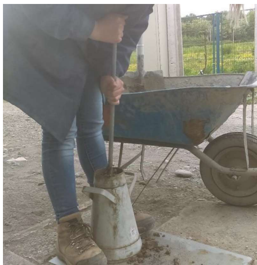
Ilustración 49: Apisonado de 1era capa. Fuente: Elaboración propia.
