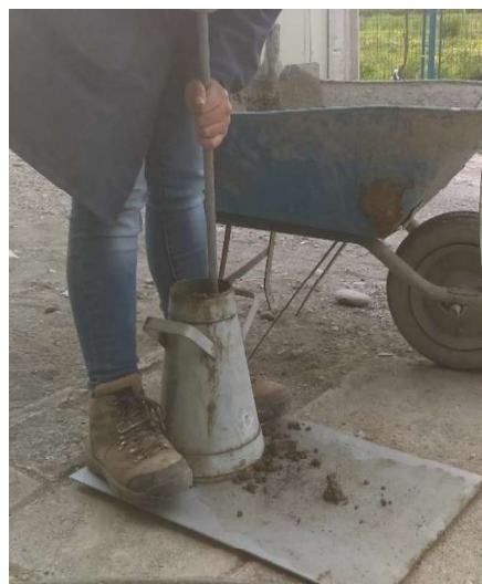
Ilustración 50: Apisonado de 2da capa. Fuente: Elaboración propia.
