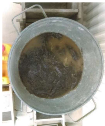
Ilustración 41: Arena saturada en agua.
