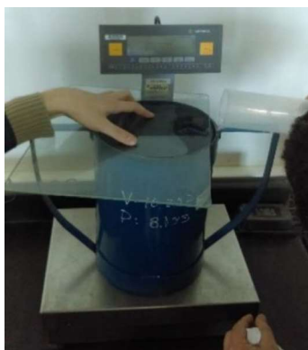
Ilustración 36: Pesaje de volumen de cilindro de grava.
