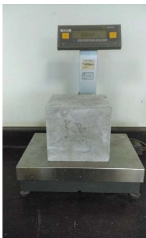
Ilustración 55: Pesaje de probeta. Fuente: Elaboración propia.
