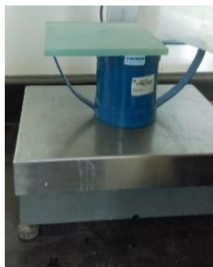
Ilustración 37: Pesaje de volumen de cilindro de arena.
