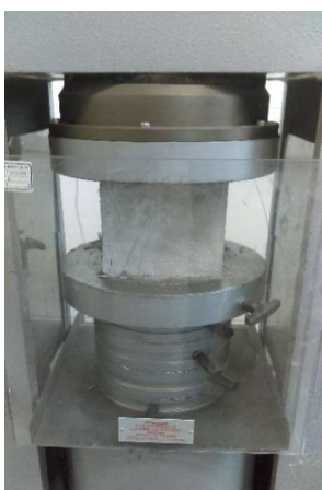
Ilustración 57: Probeta cúbica en prensa. Fuente: Elaboración propia.
