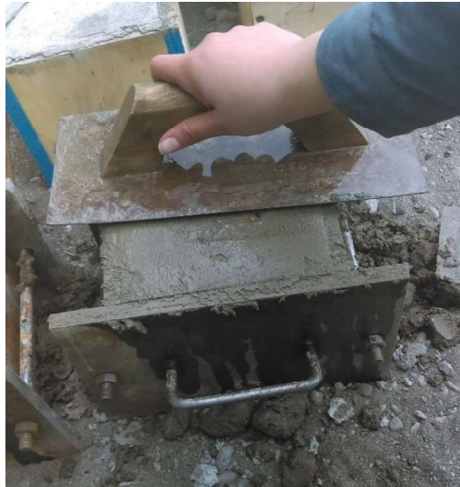
Ilustración 22: Alisado de superficie hormigón. Fuente: Elaboración propia.
