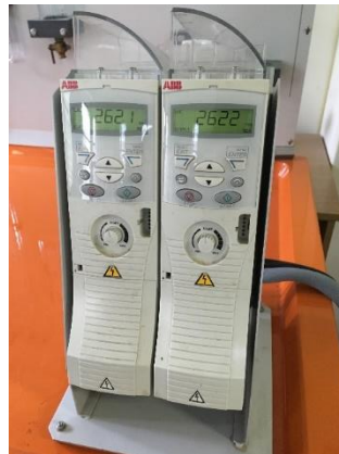
Ilustración 20: Módulo de accionamiento
