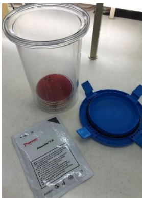
Figura 6. Jarra y generador de anaerobiosis. Posterior al sembrado de las muestras en las placas de petri, estas fueron almacenadas en jarras con óptimo sellado y un generador de anaerobiosis, siendo incubadas por 15 días a 37°C.
