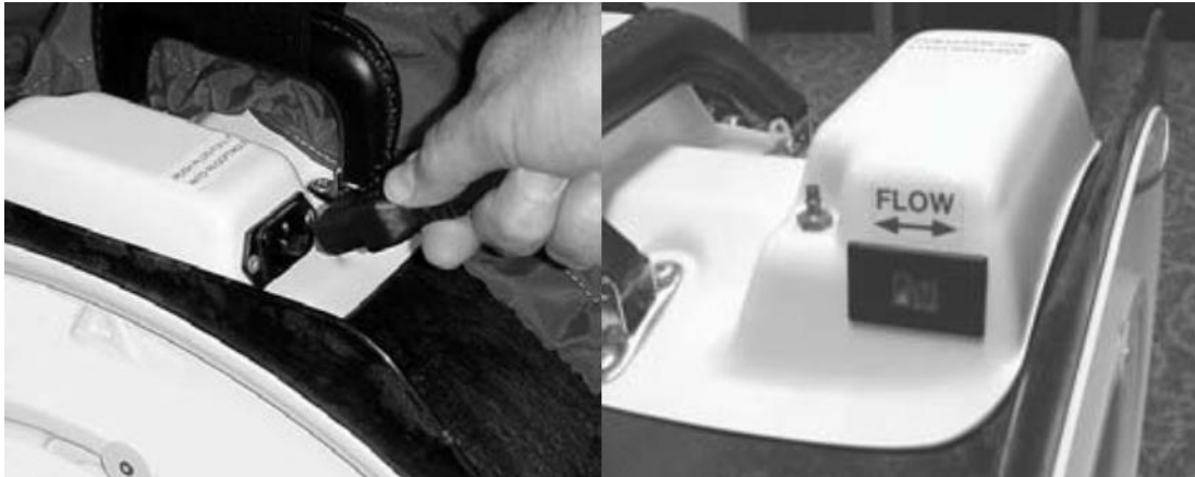
Ilustración 30: Conexión del ventilador a la corriente eléctrica
