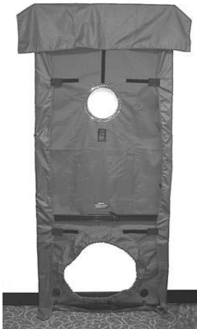
Ilustración 24: puerta de aluminio y lona de textil plástico instalados
