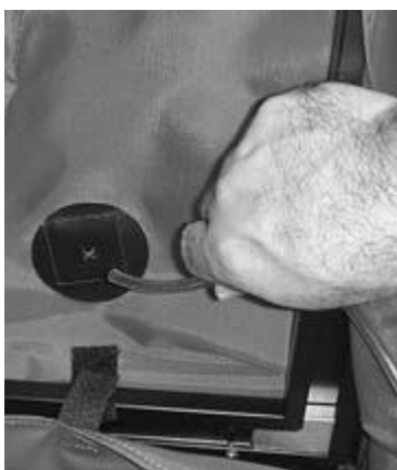
Ilustración 25: instalación extremo cable verde en la lona
