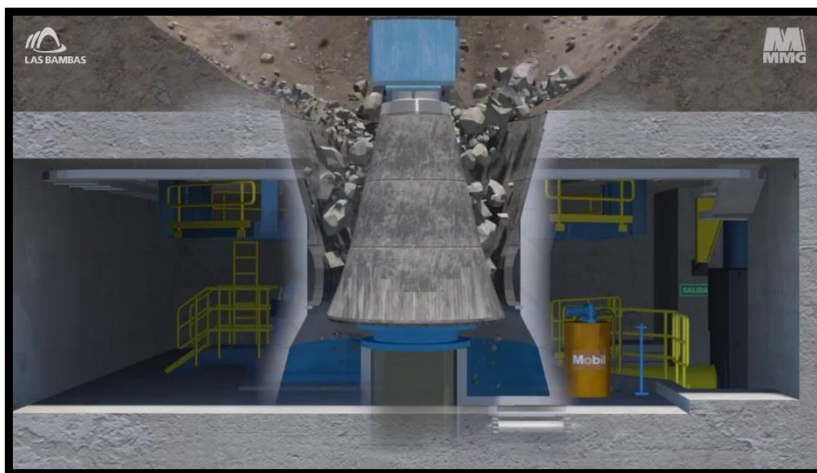
Figura 2.1: Mecanismo de conminución del chancador de Cono.
