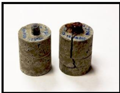
Figura 2.11: Ejemplo de corrosión por fisura o crevice.
