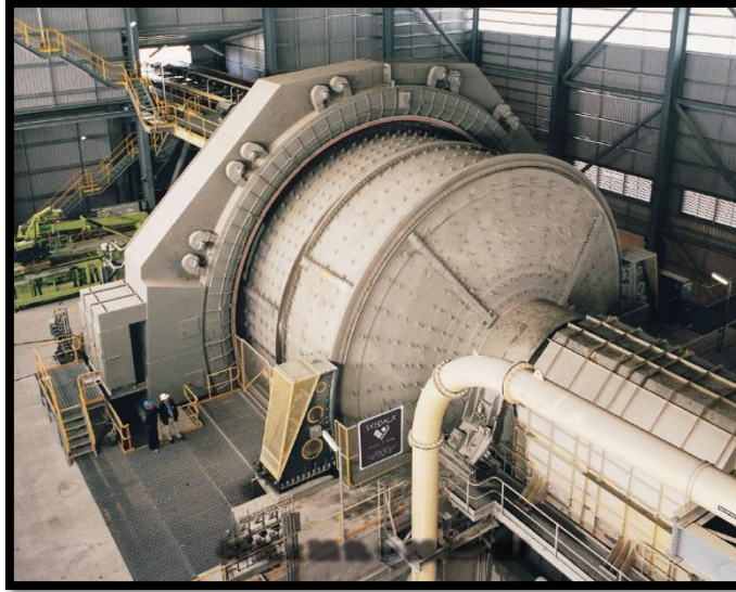
Figura 2.2: Molino SAG Minera Doña Inés de Collahuasi.
