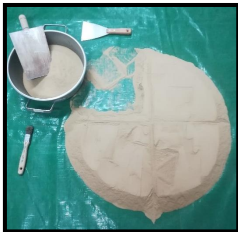
Figura 3.1: Muestreo del mineral mediante cono y cuarteo.
