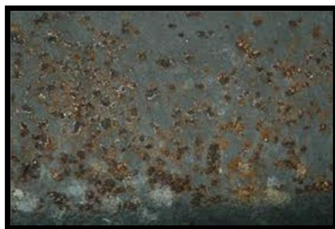
Figura 2.12: Ejemplo de corrosión por picaduras.
