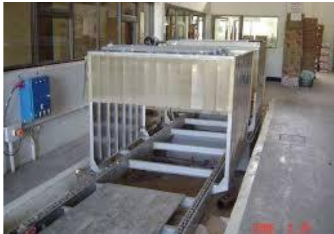
Figura 2.8 Instalaciones para tratamientos de fruta mediante drenching (Fuente: Calvo, 2012).
