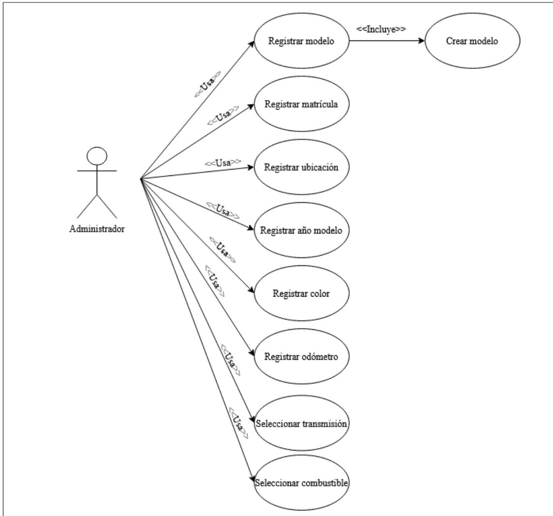
Otra de las funciones esenciales del administrador es el registro de los vehículos de la empresa, como se observa en la Figura 18, se deben registrar los siguientes aspectos de los vehículos: modelo, matricula, ubicación, año del modelo, color, odómetro, transmisión y combustible. De tal manera que sea posible diferenciar cada vehículo dentro del sistema.
