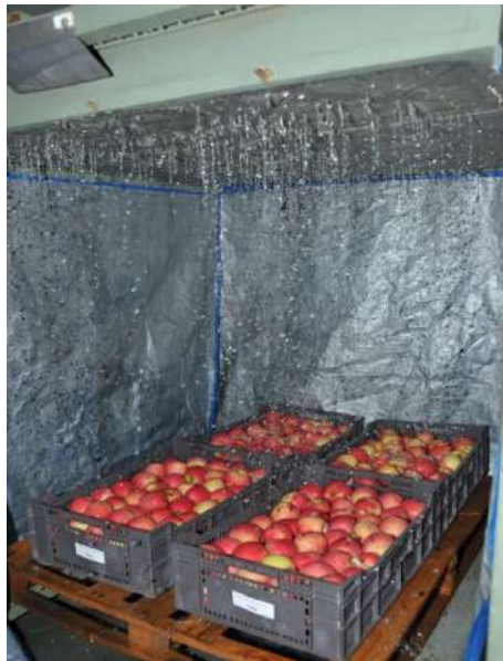
Figura 3.2. Sistema de ducha mediante recirculación (100 L) utilizado en la protección de manzanas cv. Cripps Pink. Fuente G. Díaz.
