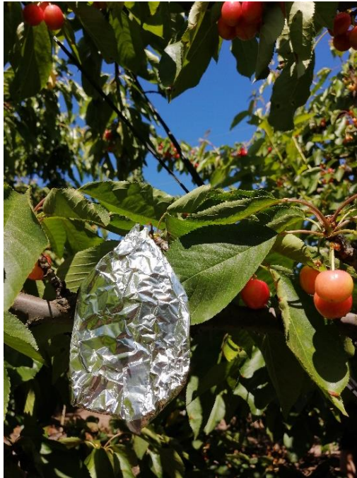
Figura 15. Hoja de cerezo ( Prunus avium L.) cubierta con papel plástico y metálico con el fin de igualar potencial de hoja con el de tallo.
