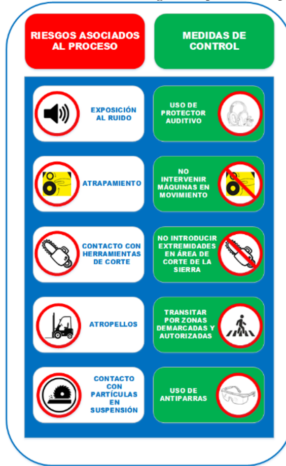
Ilustración 35: Medidas de seguridad para el área piloto
