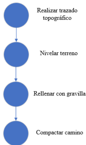
Ilustración 24: Diagrama de procesos para construcción de caminos
