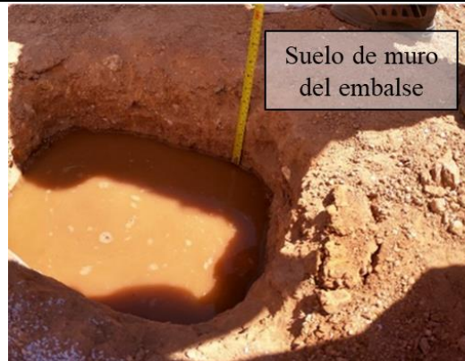
Figura 2-14. Ensayo Porchet realizado en muro de embalse de relaves Chépica, elaboración propia.
