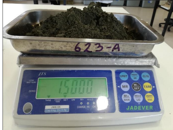
Figura 3.9: Preparación de las muestras del mineral para flotación Rougher (Elaboración propia).
