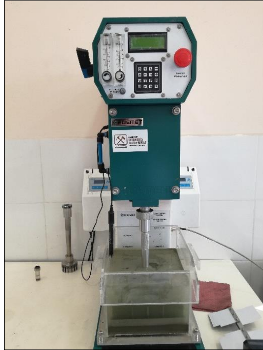
Figura 3.2: Celda de flotación EDEMET (Elaboración propia).
