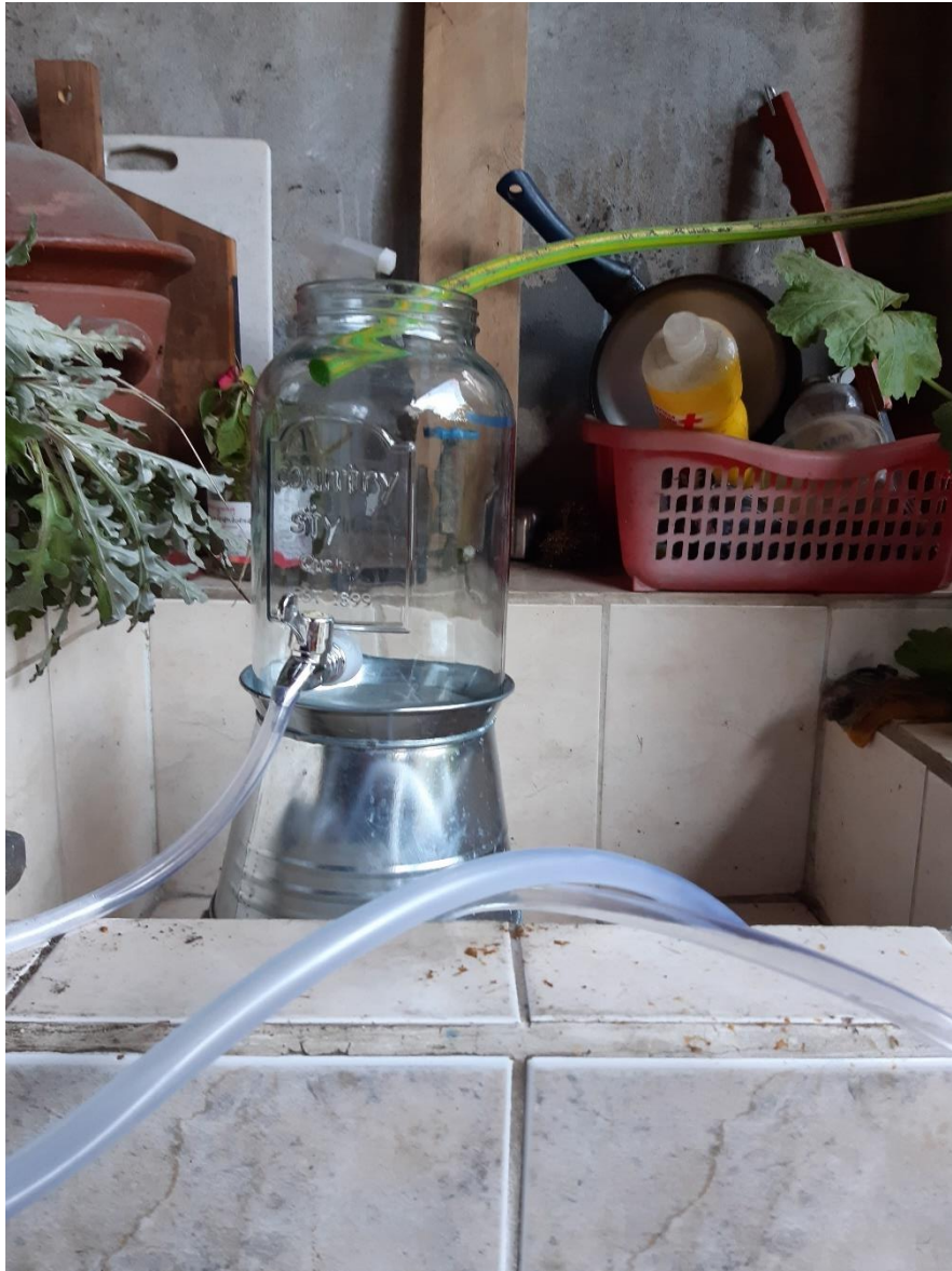
Anexo 18. Configuración de reservorio de agua a nivel constante, logrado a través de un grifo que rebalsa un estanque con una llave de paso conectada al permeámetro.
