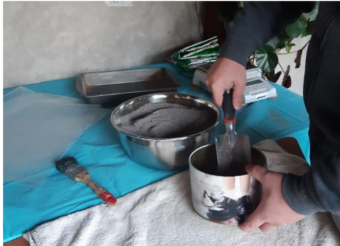
Anexo 13. Realización de ensayo de densidad mínima.
