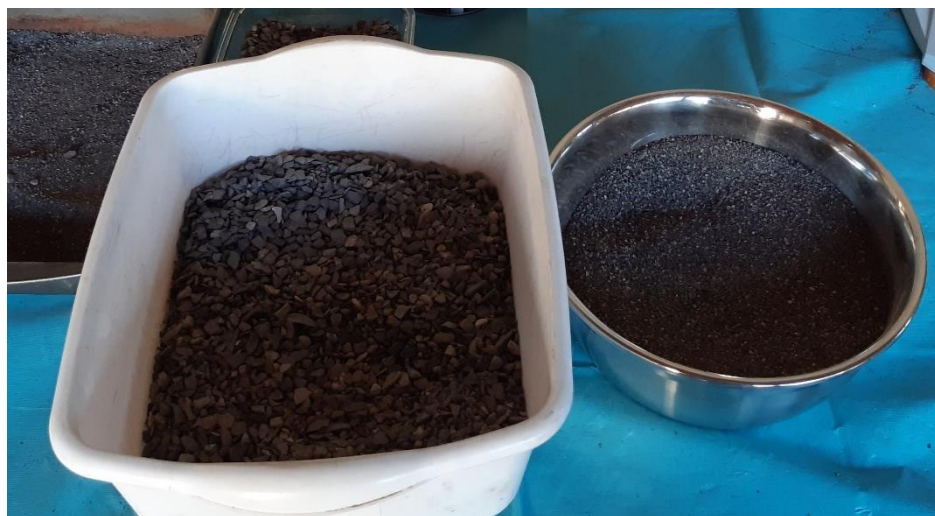
Anexo 10. Materiales de transición (izquierda) y de filtro (derecha).
