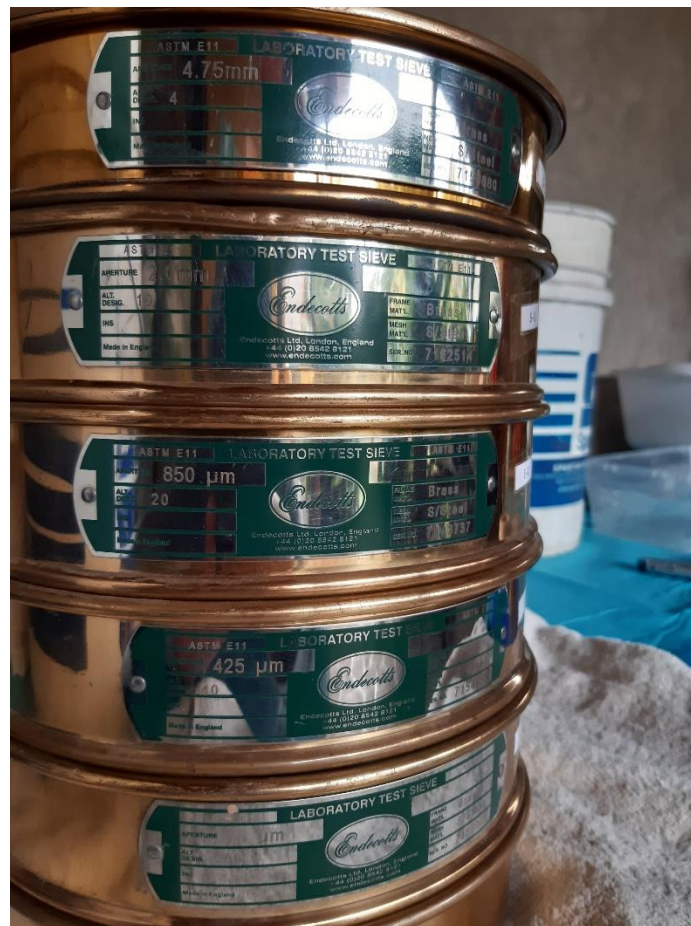
Anexo 6. Serie de tamices utilizados en el proceso de creación de materiales.
