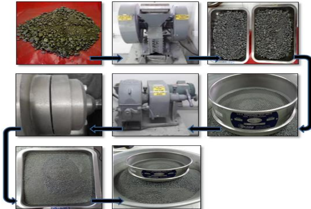
Fig. 3.4 Proceso de conminución del mineral.
