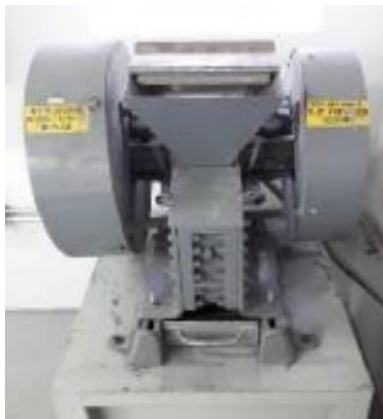
Fig. 4.5. Chancador de mandíbulas de laboratorio (izq). Pulverizador de laboratorio (der).
