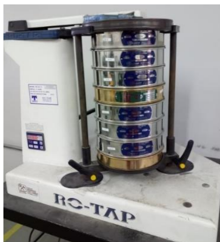
Fig. 4.1 Equipo Ro-Tap (izq). Balanza semi-micro analítica (der).
