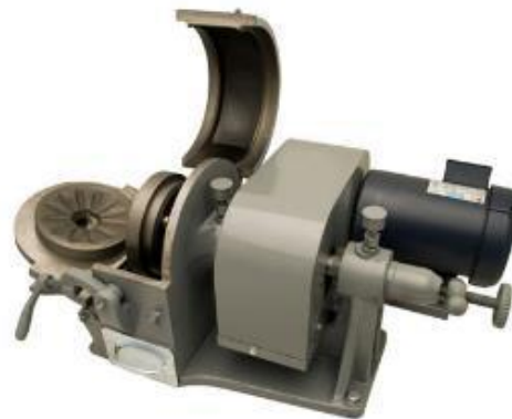
Fig. 4.5. Chancador de mandíbulas de laboratorio (izq). Pulverizador de laboratorio (der).
