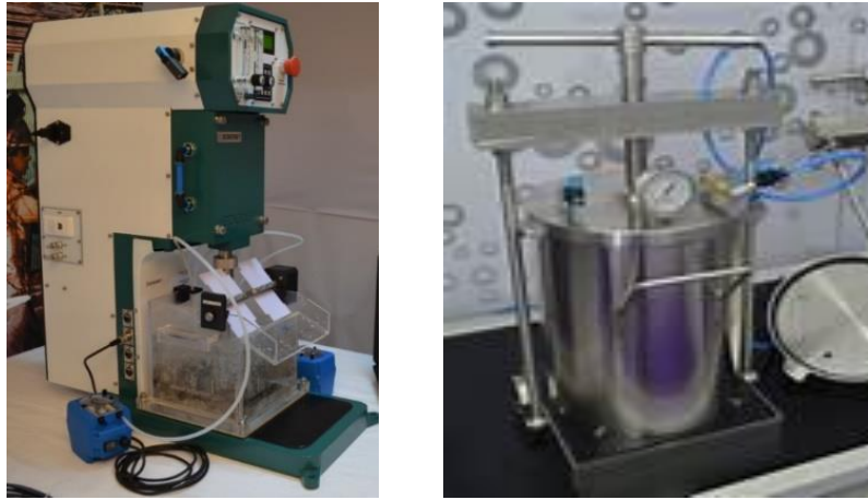
Fig. 4.8 Celda de Flotación de laboratorio (izq). Filtro a Presión (der). (Edemet, 2020)
