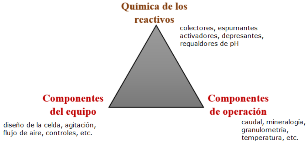
Fig. 2.13 Conjunto base del proceso Flotación Espumante (Bustamante, 2017)
