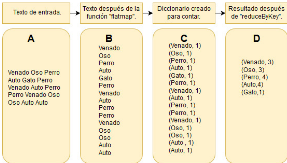
Figura 2.7: Funcionamiento de WordCount en Spark
