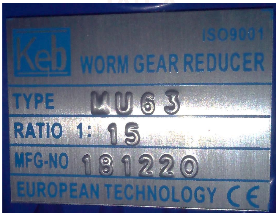
Figura 7.4: Placa reductor sin fin corona marca Keb instalado[43].
