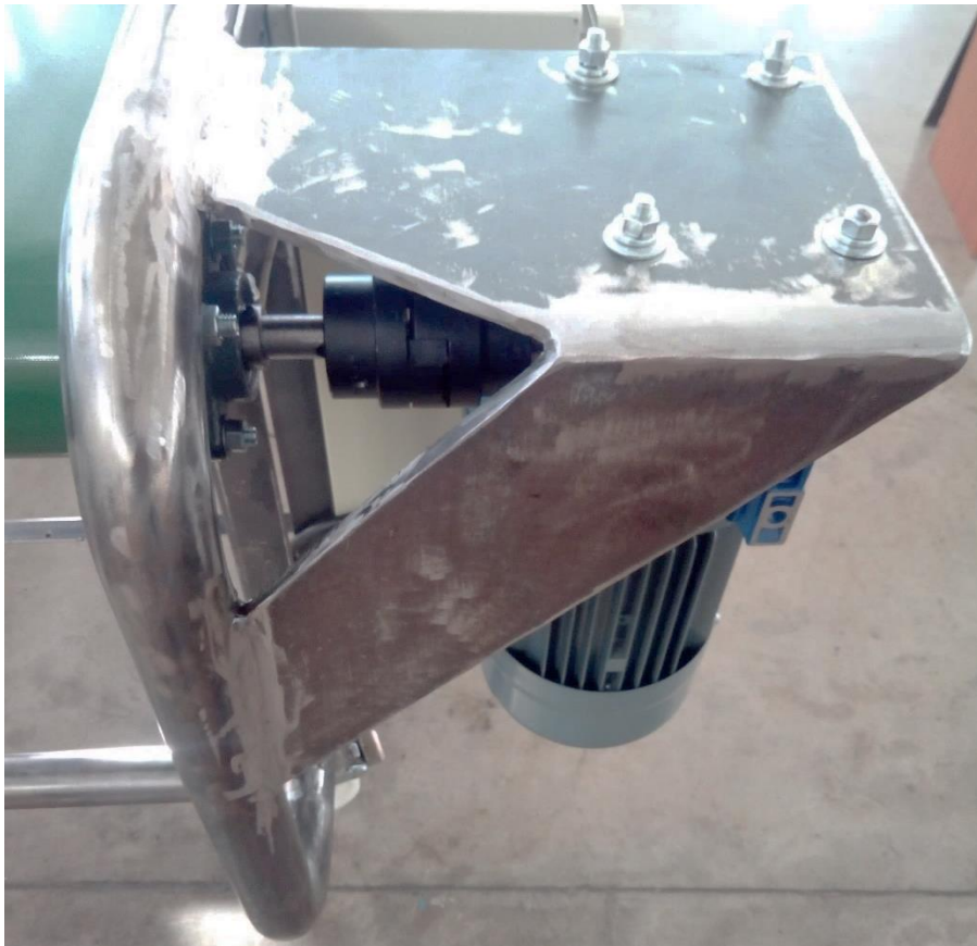
Figura 7.12: Acople flexible Fenner instalado, Vista 2.
