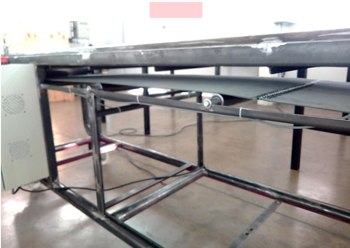
Figura 7.22: Polines instalados en el transportador, Vista 1.
