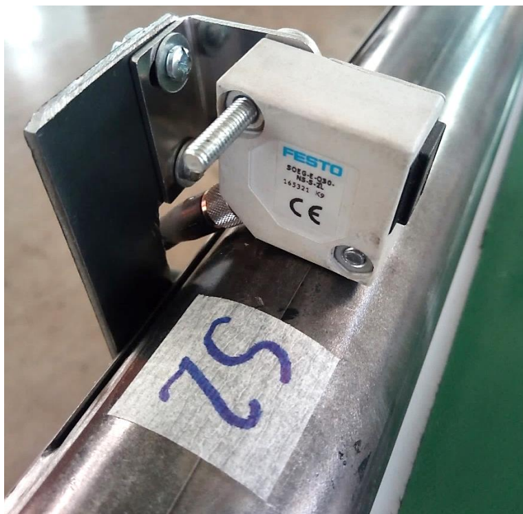
Figura 7.40: Sensor Receptor barrera de luz SOEG-E-Q30-NS-S-2L instalado.
