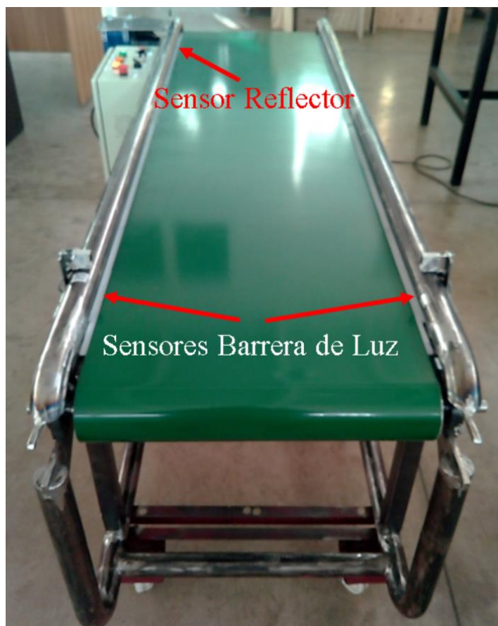
Figura 7.37: Ubicación de los sensores fotoeléctricos instalados.
