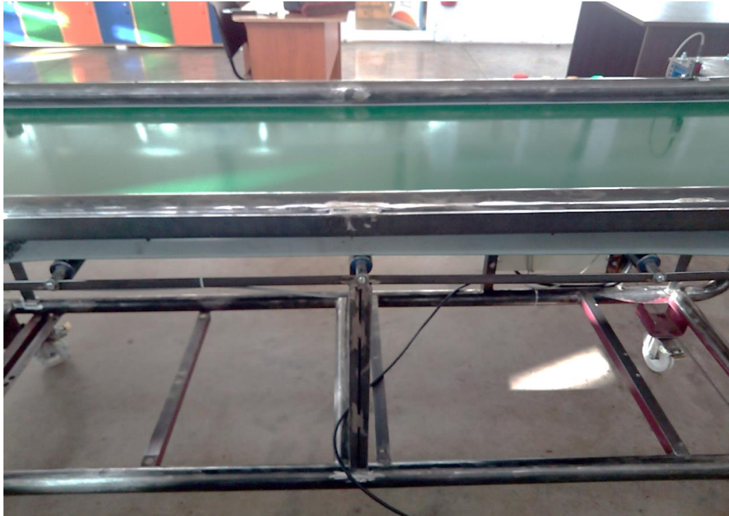
Figura 7.23: Polines instalados en el transportador, Vista 2.
