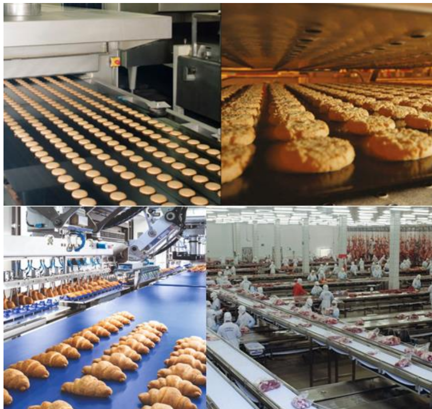
Figura 2.9: Cinta transportadora utilizada en industria de alimentos[12][13].
