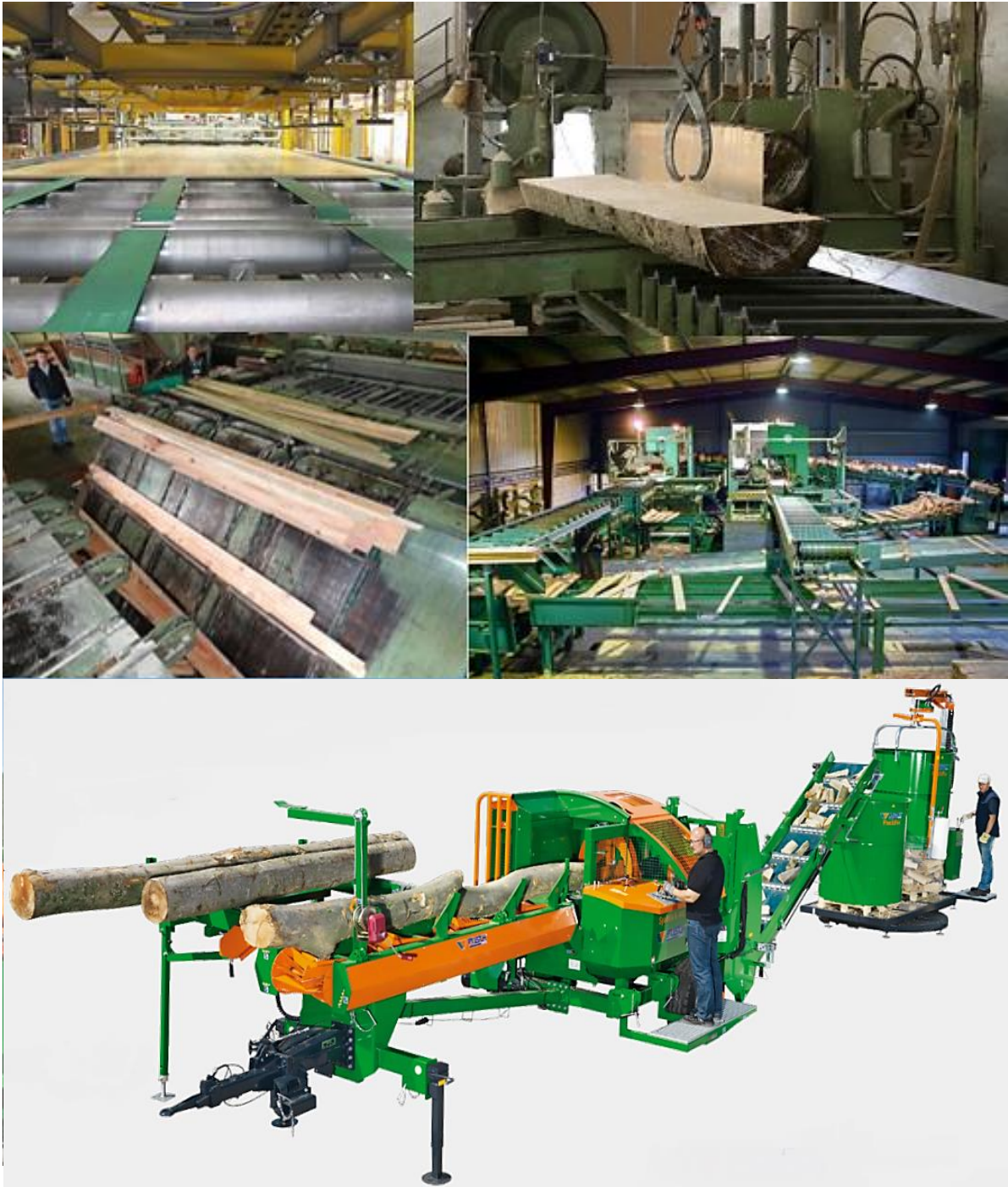
Figura 2.11: Cinta transportadora utilizada en industria de madera [22][23].
