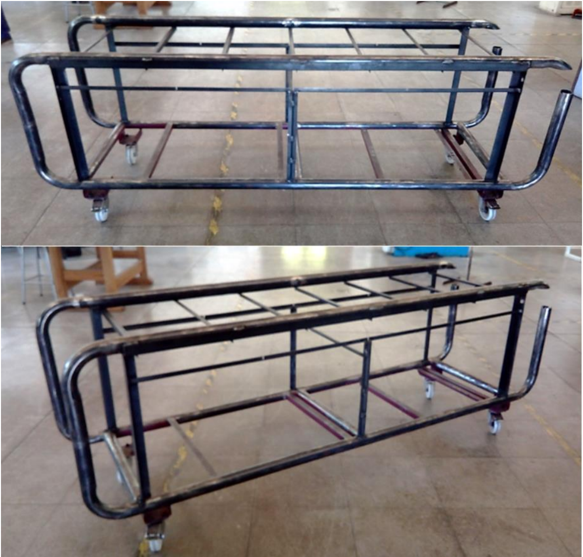
Figura 8.8: Etapa final de la construcción de la estructura del transportador.
