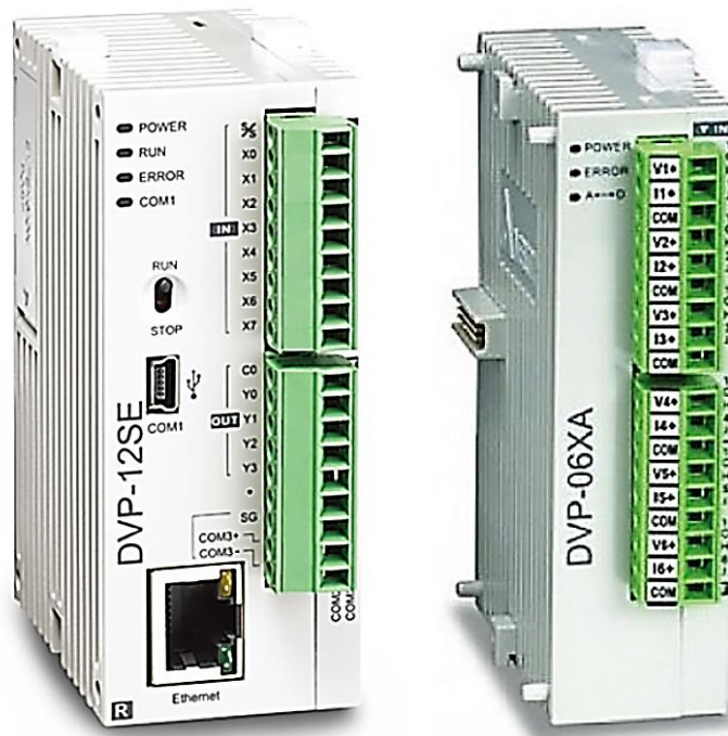
Figura 7.27: PLC y Módulo analógico instalados [47].
