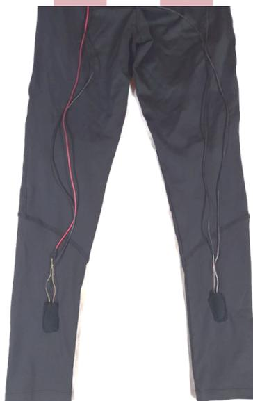
**Fig. 3.4** Modelo de pruebas con DEMV en pantorrilla
