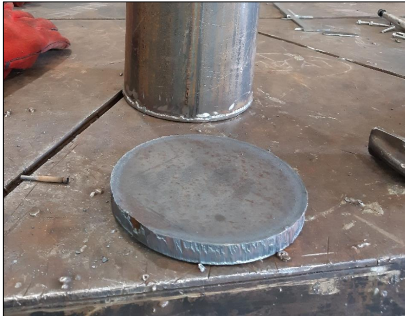
Ilustración 56: Tapa superior de estanque cortada por plasma. Fuente: Elaboración propia.
