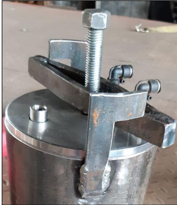
Ilustración 60: Sistema de cerradura de estanque hidroneumático. Fuente: Elaboración propia.
