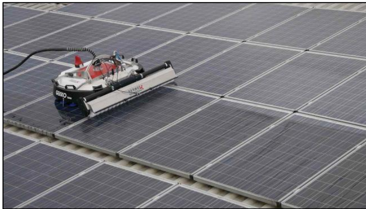
Ilustración 10: Robot GEKKO Solar remoto. Fuente: www.serbot.ch .
