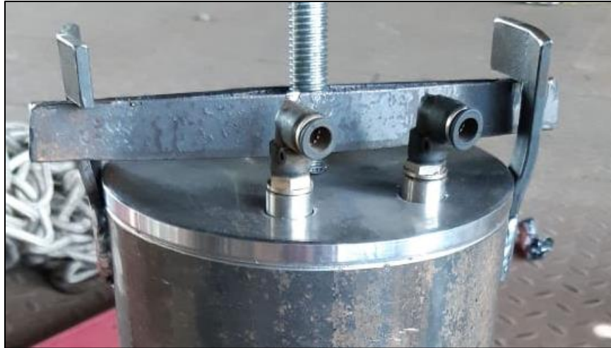
Ilustración 58: Montaje piping en tapa superior. Fuente: Elaboración propia.
