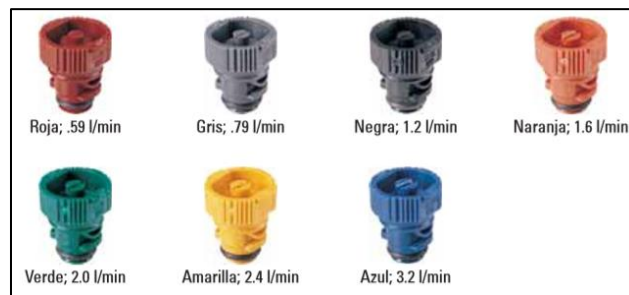
Ilustración 36: Boquillas de aspersión plana, miniatura ProMax Quick Veejet modelo QMVV. Fuente: Catálogo 70M de Spraying System Co ®.
