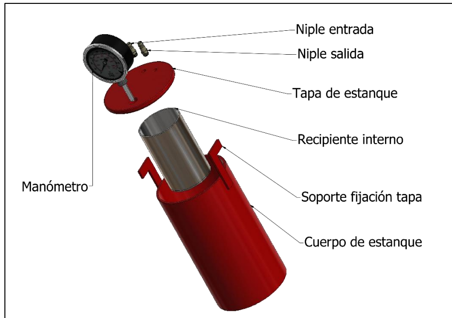
Ilustración 47: Tanque hidroneumático, vista explosionada. Fuente: Elaboración propia.
