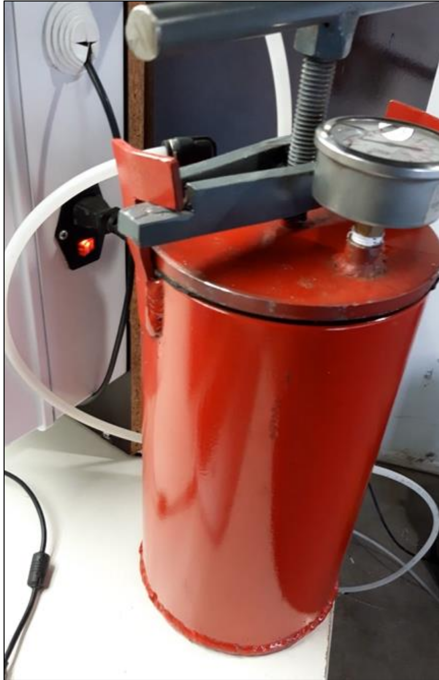
Ilustración 71: Estanque hidroneumático montado en planta. Fuente: Elaboración propia.
