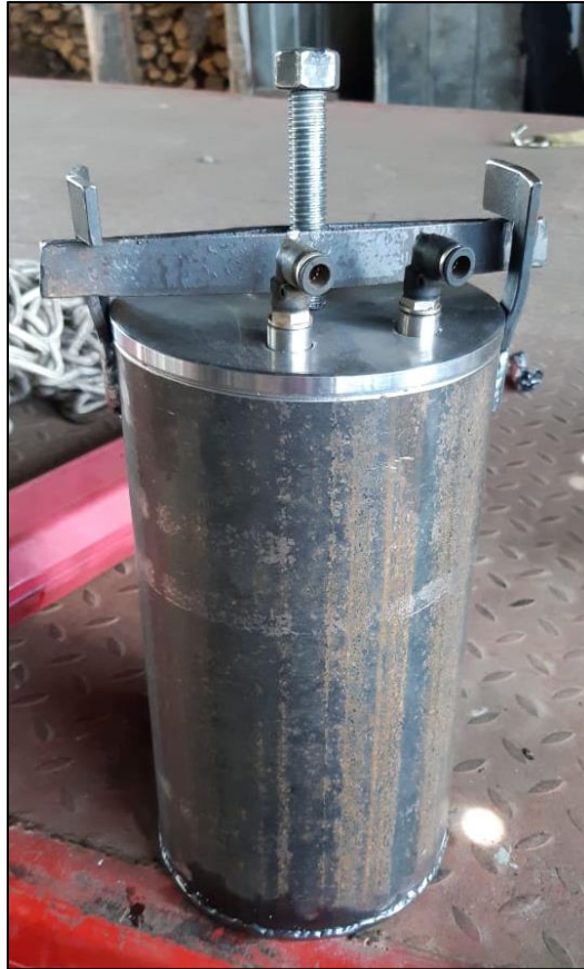
Ilustración 53: Estanque hidroneumático. Fuente: Elaboración propia.
