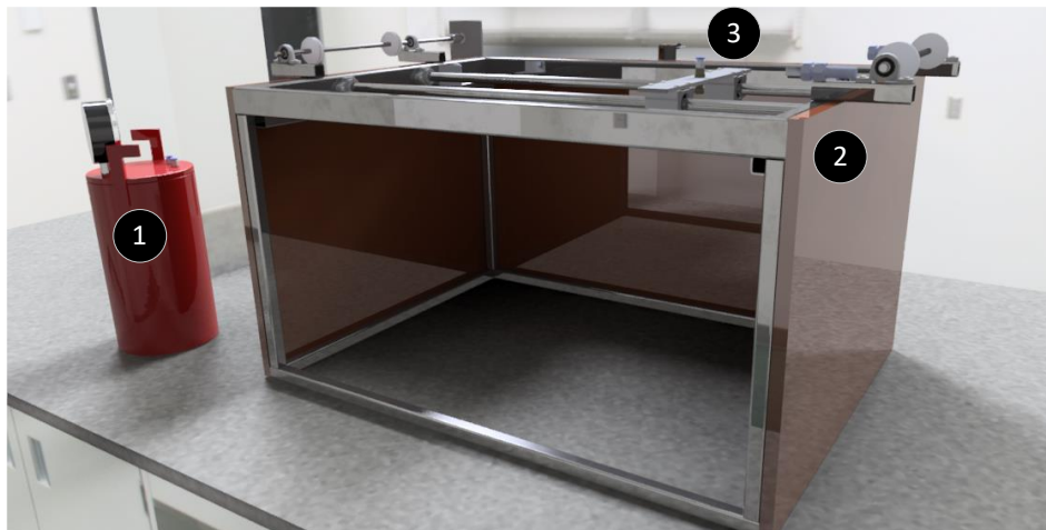
Ilustración 32: Cámara de recubrimientos propuesta. Fuente: Elaboración propia.
