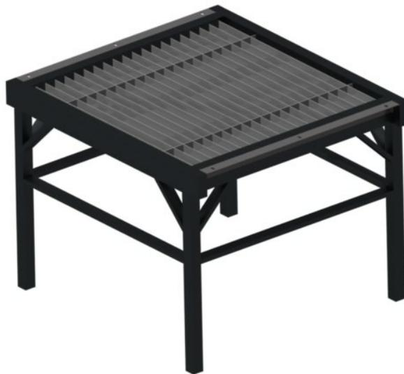
Figura 12 Estructura de banco para corte.
