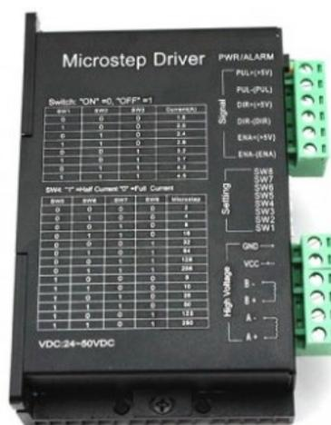
Figura 24 Driver control motor a pasos.
