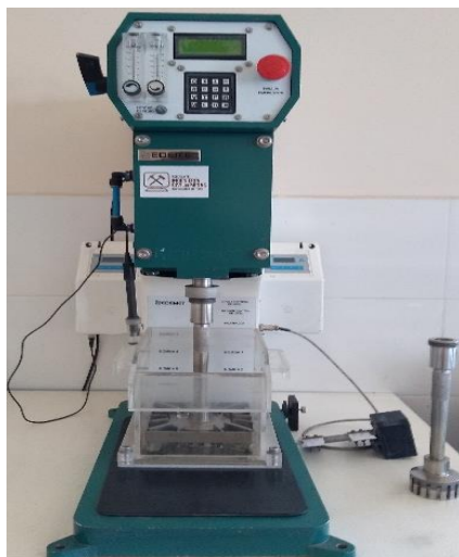
Figura 3.3 Montaje de la Celda de Flotación (EDEMET).
