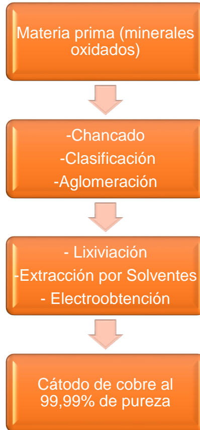
Figura 2 Diagrama de flujo del proceso de obtención de cátodos de cobre a partir de minerales oxidados Fuente: (Muñoz, 2016)
