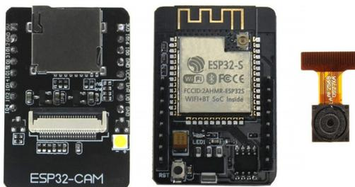
Fig. 10: Módulo ESP32-CAM.
