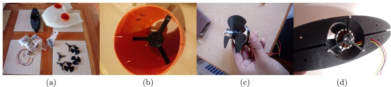
Fig. 3.18: a) conjunto de piezas a ensamblar. b) configuración de encamisado y soporte motor. c) ensamble de hélice-motor. d) ensamble del soporte motor a la cola, motor y hélice.
