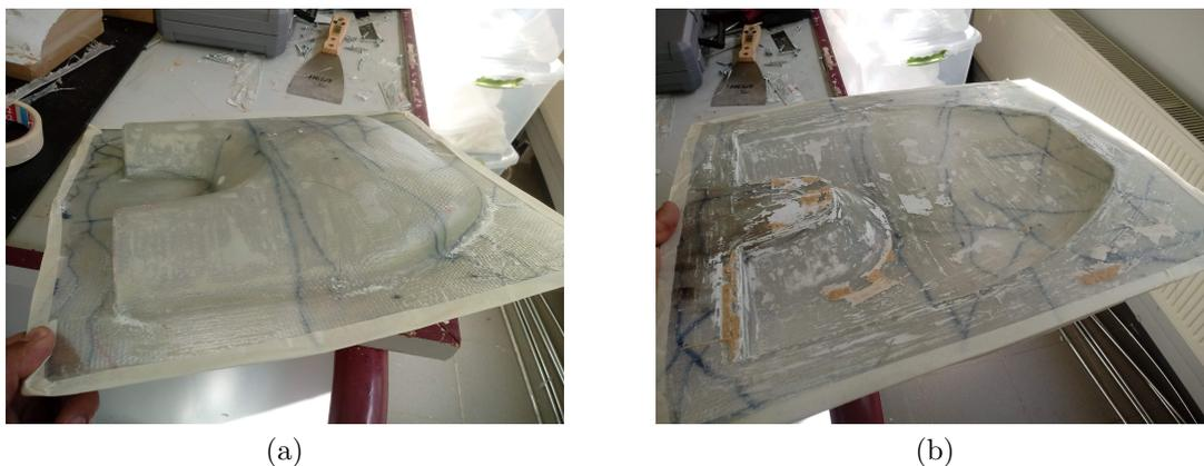
Fig. 3.4: a) molde de fibra de vidrio. b) cara útil del molde de fibra de vidrio.
