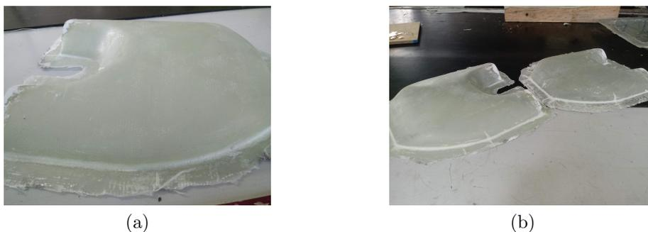
Fig. 3.12: a) carcasa de fibra de vidrio. b) carcasas simétricas.
