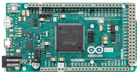
Fig. 4.1: Arduino DUE. Fuente: [20]
