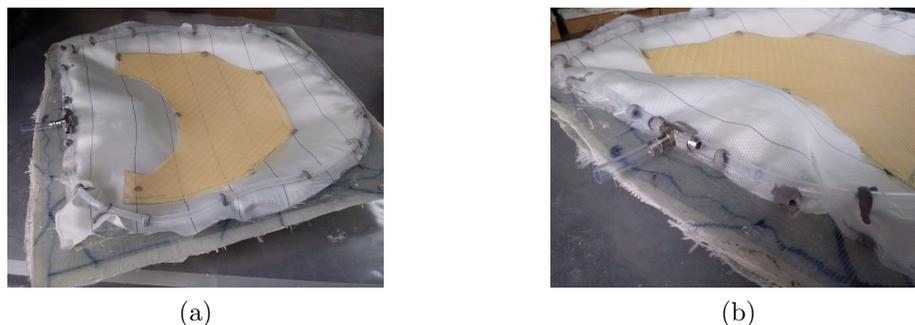
Fig. 3.9: a) adhesión de mangueras, conexión T y peel ply al molde. b) vista cercana de la adhesión de algunos insumos al molde mediante el pegote.
