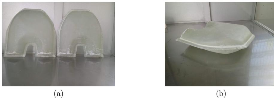
Fig. 3.13: a) mecanizado de pestañas en carcasas. b) vista isométrica de carcasas.
