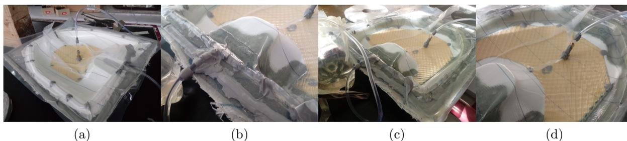
Fig. 3.10: a) instalación de bolsa de vacío y prueba de vacío. b) conexión de manguera de vinilo a conector tipo T para la inyección de resina al molde. c) inyección de resina al vacío. d) vista cercana de inyección de resina al vacío.
