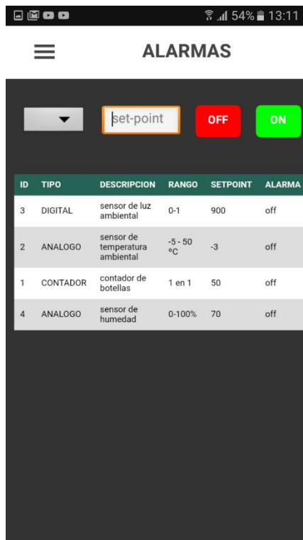
Fig. 3.7 Imagen pantalla de alarmas aplicación.
