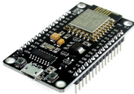
Fig. 2.9 Imagen referencia tarjeta Nodemcu.
