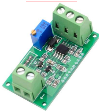
Fig. 2.11 Imagen referencia modulo conversor corriente a voltaje.
