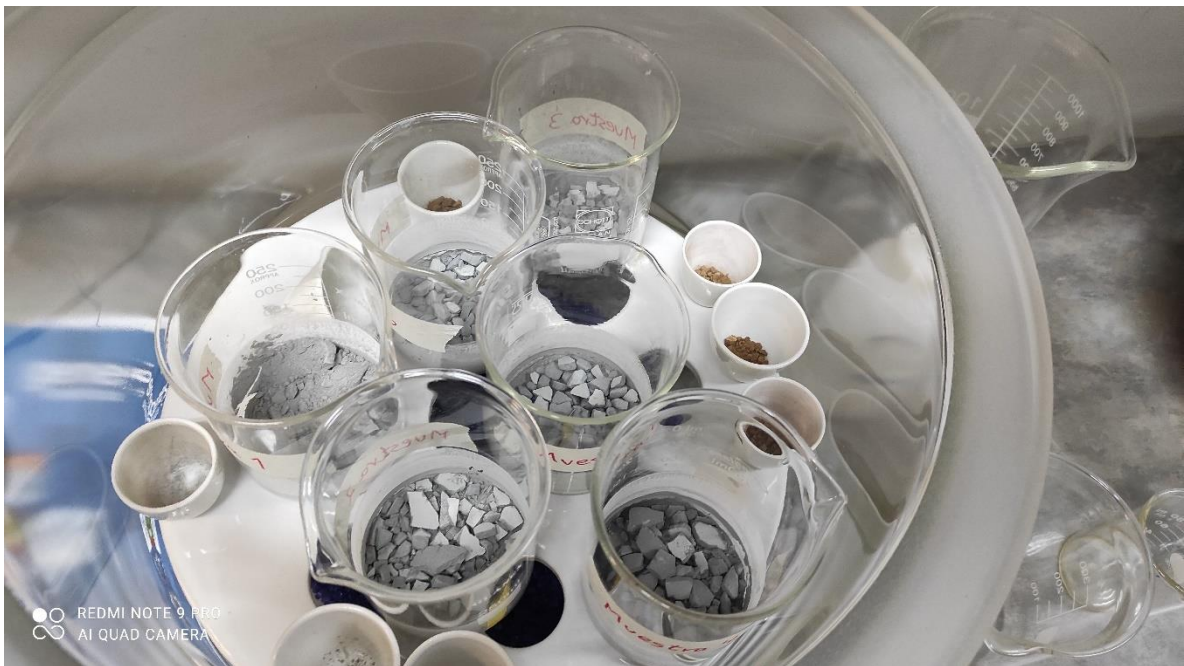
Figura 4.2: Vasos precipitados con la muestra seca de los análisis sólidos totales. Fuente: Elaboración propia
