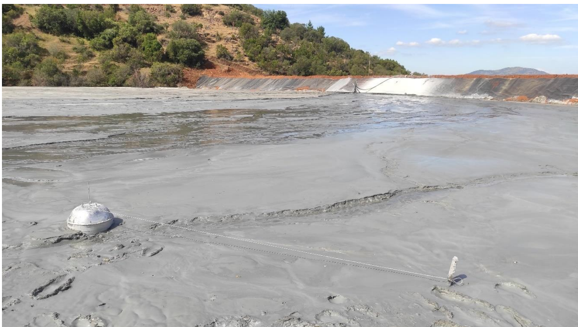
Figura 3.7: Campana metálica puesta en el embalse de relaves. Fuente: Elaboración propia
