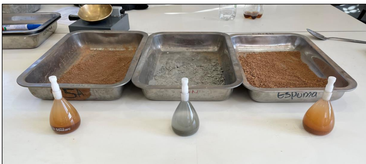
Figura 7.3: Ensayo para determinar la Gravedad específica.
