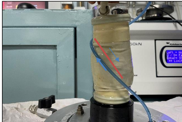
Figura 4.22: Probeta fallada del muro de empréstito (Elaboración propia).
