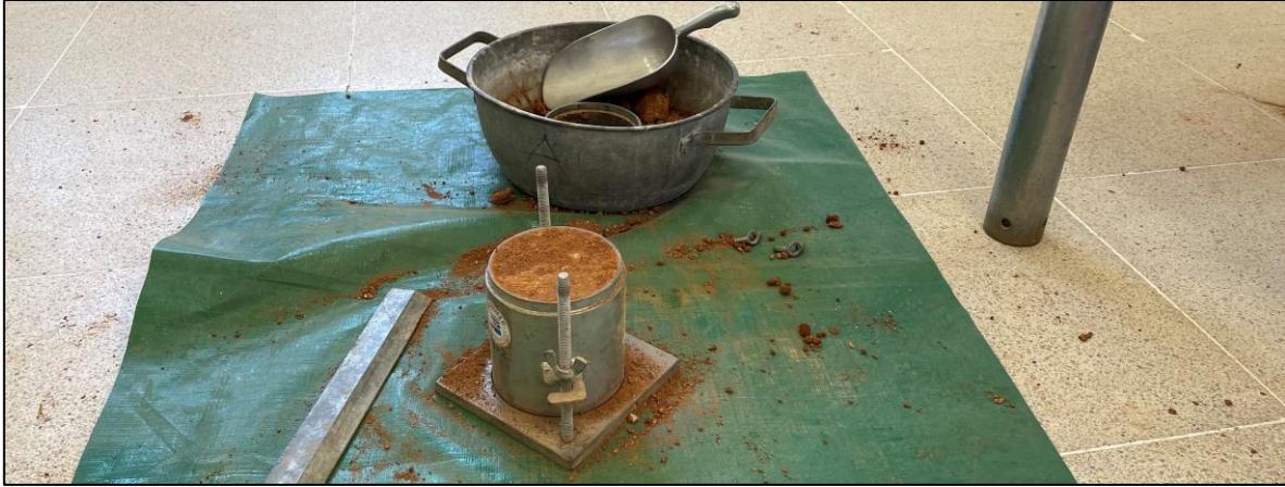
Figura 7.4: Suelo compactado por Proctor modificado.
