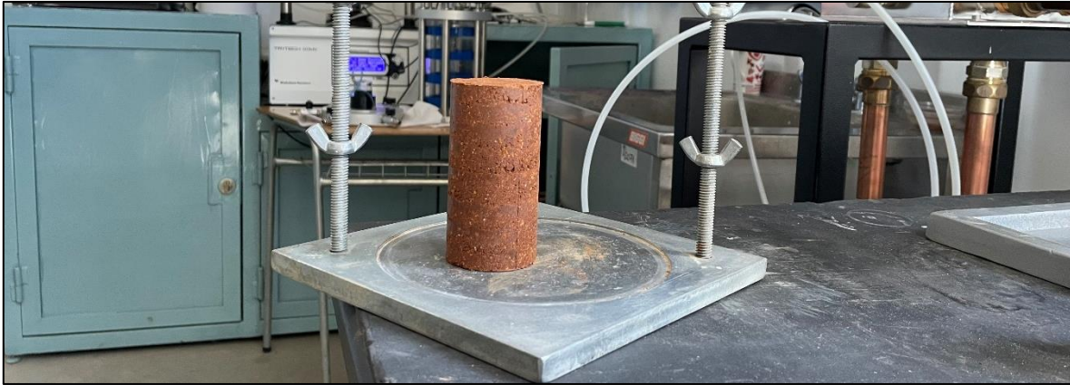
Figura 4.16: Probeta remoldeada del Material Muro de Empréstito (Elaboración propia).
