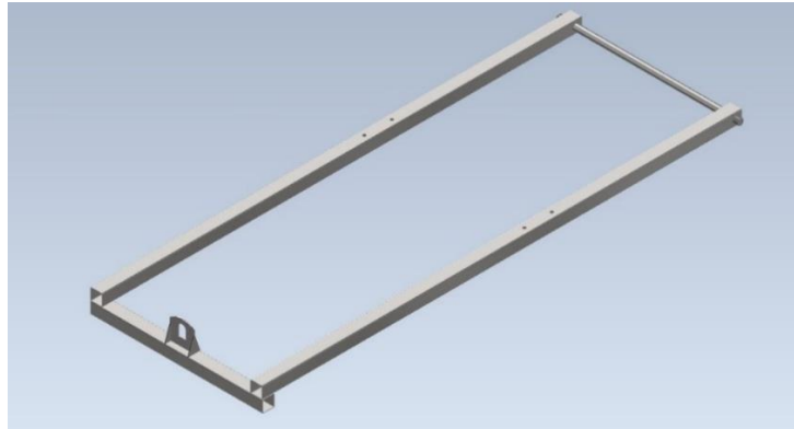
Figura 4-5: Plataforma pivotante de la rueda hidráulica.
