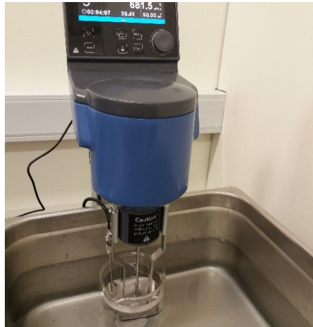
Figura Anexo 4.4 Reómetro ROTAVISC LO VI instalado en la fuente termorreguladora y muestra de 200 ml de Glicerina
