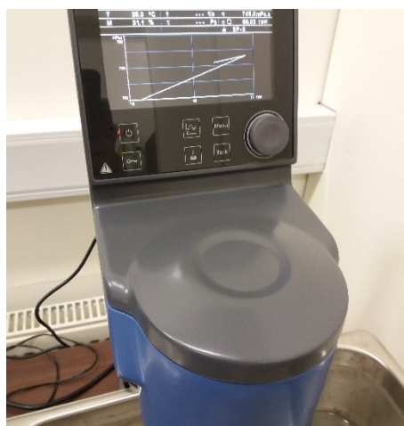
Figura Anexo 4.8 Gráfica de Viscosidad vs Velocidad de giro de husillo en RPM obtenida por pantalla.
