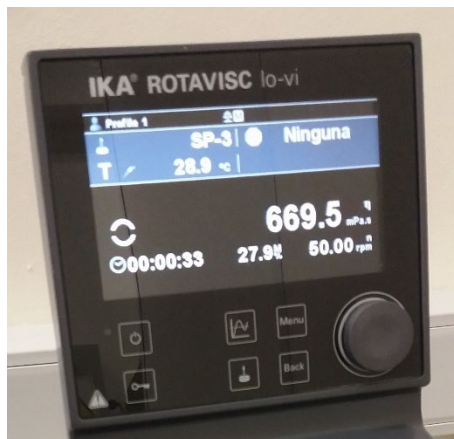
Figura Anexo 4.7 Valores de viscosidad obtenidos por pantalla mediante análisis a los 33 segundos y con una velocidad de giro de husillo de 50 RPM.
