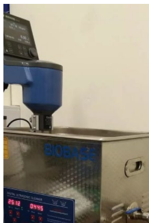
Figura Anexo 4.5 Reómetro ROTAVISC LO VI instalado en la fuente termorreguladora con una temperatura inicial de 25° C
