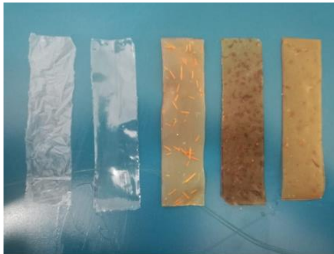
Figura 3-11: Probetas estandarizadas de 10 x 2.6 cm y espesor variado por temas del origen de las muestras. De izq. a derecha: Bolsa común-bolsa Ziploc-Material almidón de papa y tomate-Material almidón de maíz y manzana-Material almidón de papa y manzana. Fuente: Elaboración propia
