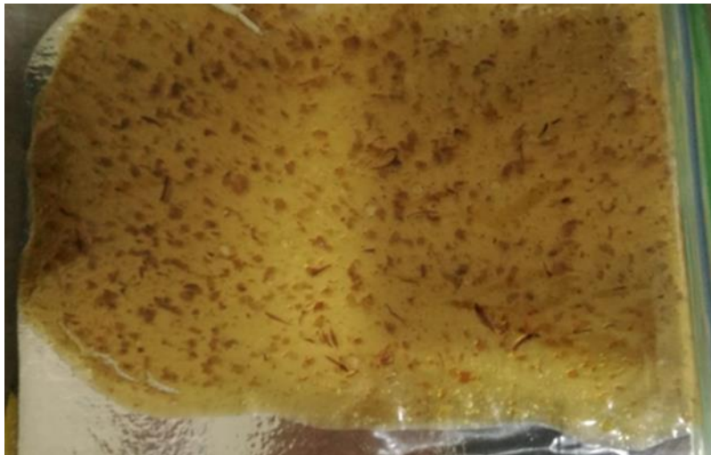
Figura 3-8: Material tipo F1: biopolímero de manzana modificado, fabricado en base a almidón de maíz, pulpa de desecho de manzana (60gr pulpa de manzana 40ml de agua). Fuente: Elaboración propia
