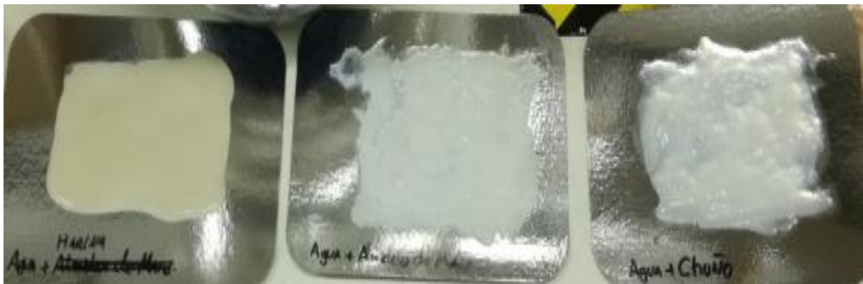
Figura 3-2: Muestras de engrudos esparcidos sobre superficie plana y limpia. De izq. a der. Engrudo de harina, almidón de maíz y chuño. Fuente: Elaboración propia.
