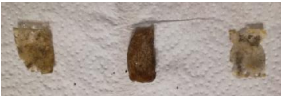
Figura 4-4: Probetas sometidas a la intemperie día 4. De izq. a derecha Material tipo F1, C2 y D3. Fuente: Elaboración propia.
