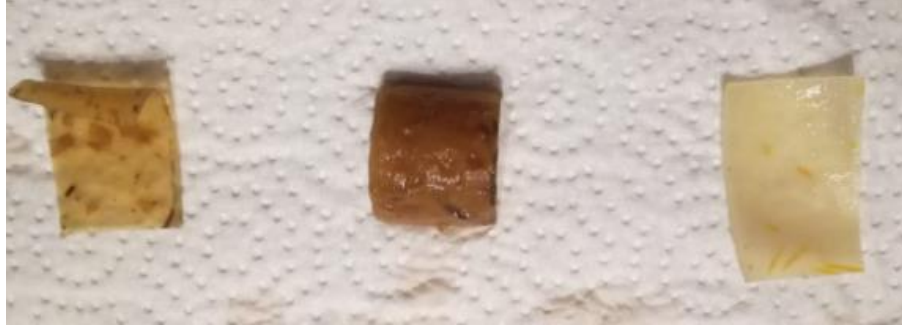
Figura 4-2: Probetas sometidas a medio líquido día 4. De izq. a derecha Material tipo F1, C2 y D3. Fuente: Elaboración propia.
