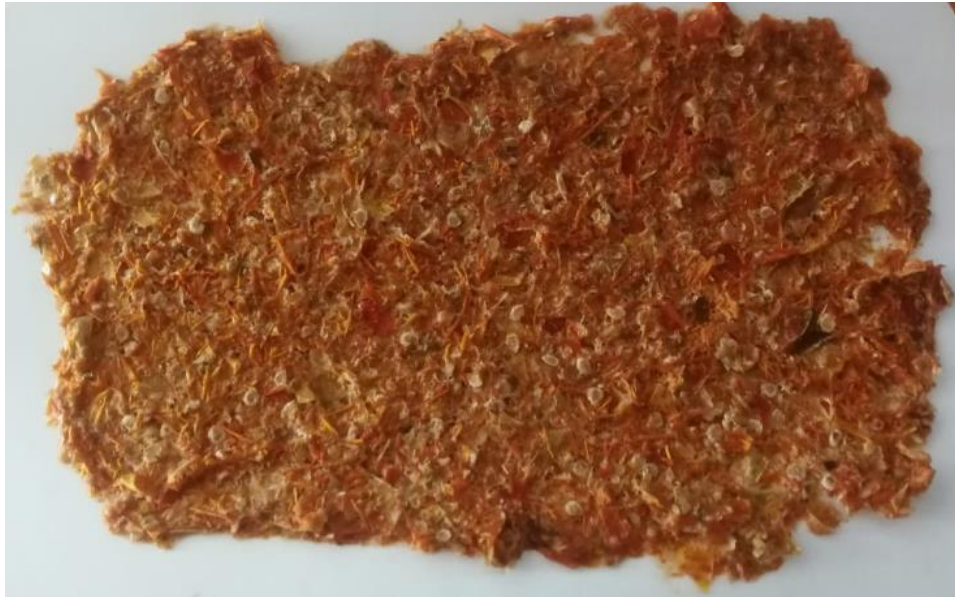
Figura 3-9: Material tipo F2: biopolímero de tomate modificado, fabricado en base a almidón de papa, Tomasa (piel y semilla del tomate). Fuente: Elaboración propia
