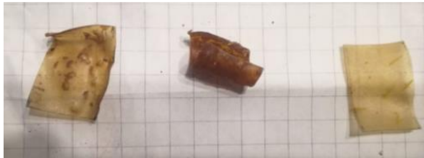
Figura 4-9: Probetas sometidas a medio rocoso y seco día 12. De izq. a derecha Material tipo F1, C2 y D3. Fuente: Elaboración propia.
