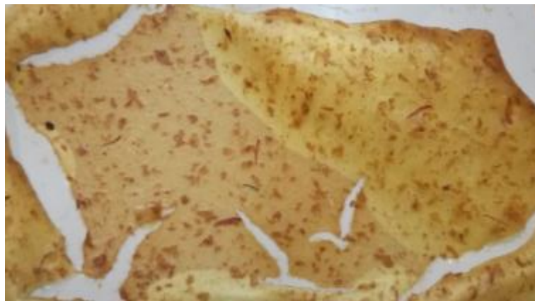
Figura 3-10: Material tipo G2: biopolímero de manzana modificado, fabricado en base a almidón de maíz, pulpa de desecho de manzana, glicerina en doble proporción a la inicial. Fuente: Elaboración propia
