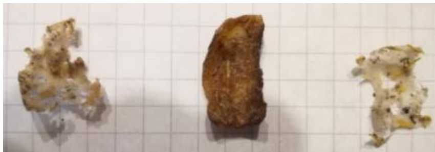
Figura 4-7: Probetas sometidas a la intemperie día 8. De izq. a derecha Material tipo F1, C2 y D3. Fuente: Elaboración propia.
