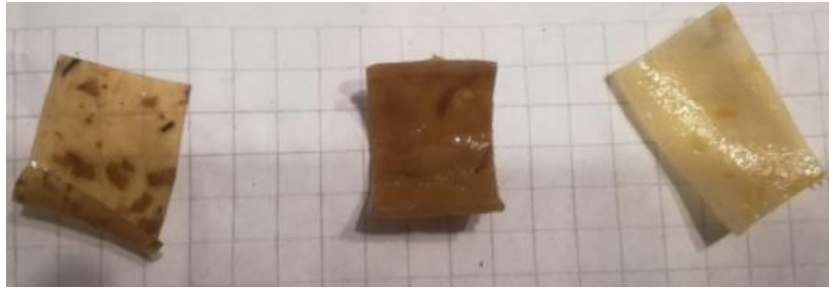
Figura 4-8: Probetas sometidas a medio líquido día 12. De izq. a derecha Material tipo F1, C2 y D3. Fuente: Elaboración propia.
