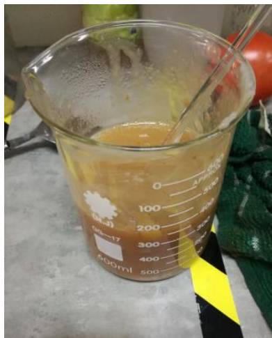
Figura 3-5: Muestra de biopolímero fabricada con material de desecho de manzana. Fuente Elaboración propia
