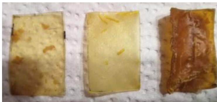
Figura 4-1: Probetas estandarizadas de 2 x 3,5 cm De izq. a derecha: Material F1, D3, C2. Fuente: Elaboración propia.
