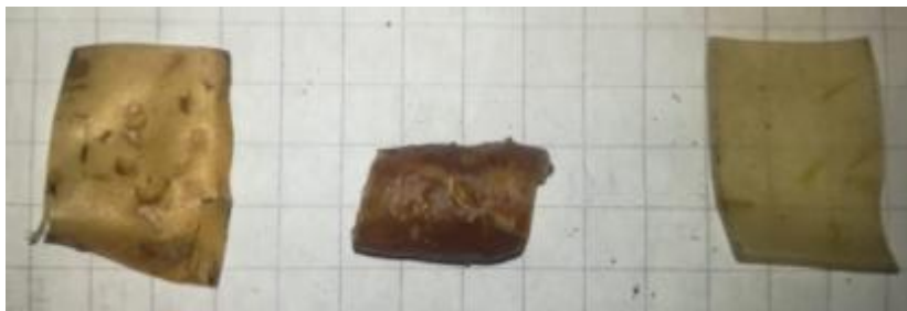
Figura 4-12: Probetas sometidas a medio rocoso y seco día 24. De izq. a derecha Material tipo F1, C2 y D3. Fuente: Elaboración propia.
