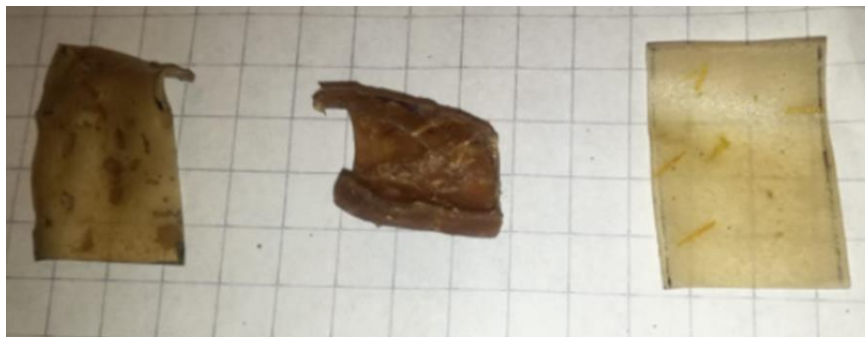
Figura 4-6: Probetas sometidas a medio rocoso y seco día 8. De izq. a derecha Material tipo F1, C2 y D3. Fuente: Elaboración propia.
