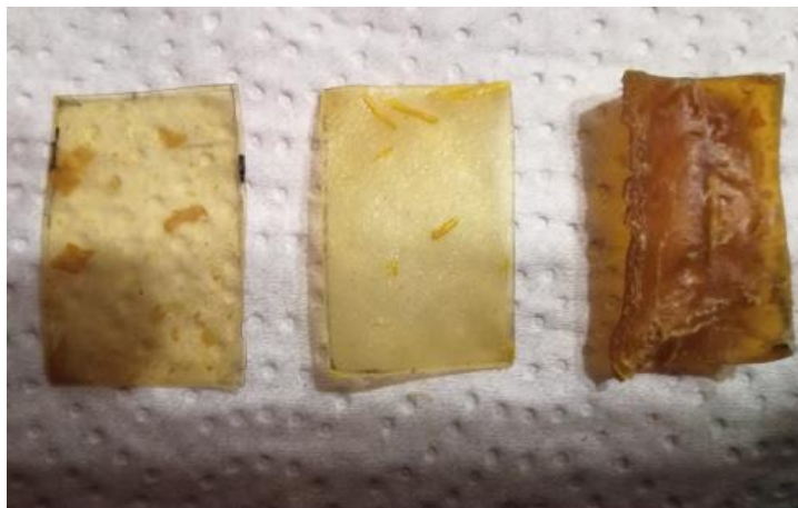
Figura 3-12: Probetas estandarizadas de 2 x 3,5 cm y espesor variado por temas del origen de las muestras. De izq. a derecha: Material F1, D3, C2. Fuente: Elaboración propia
