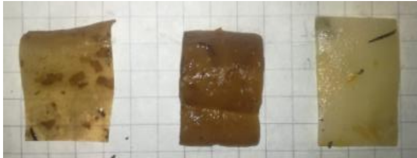
Figura 4-11: Probetas sometidas a medio líquido día 24. De izq. a derecha Material tipo F1, C2 y D3. Fuente: Elaboración propia.
