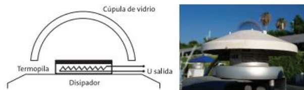
Figura 2.5: Diagrama y foto de un piranómetro. Fuente: (García Valladares & Pilatowsky Figueroa, 2017)
