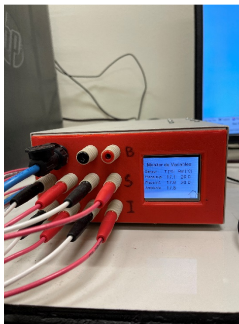
Figura 3.6 Controlador de temperatura Fuente: Laboratorio ingeniería de procesos.
