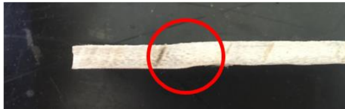
Figura 4.11: Defecto de fabricación en el prototipo (Propia, 2020).
