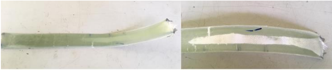
Figura 3.29: Falla de fabricación por no impregnación en laminas inferiores (Propia, 2020).
