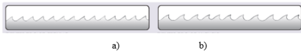
Ilustración 29: Sierra de cinta con paso a) regular y b) variable.
