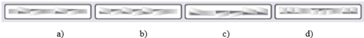
Ilustración 30: Disposición de dientes a) regular b) variable c) a pares y d) ola
