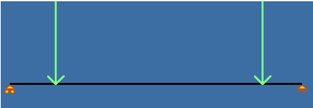
Ilustración 39: Diagrama cuerpo libre de perfil travesaño
