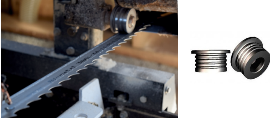
Ilustración 41: Hoja de sierra BAHCO 3861 Sandcut Bimetal
