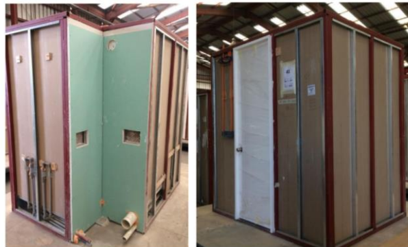
Figura N°35: Baños prefabricados exterior
