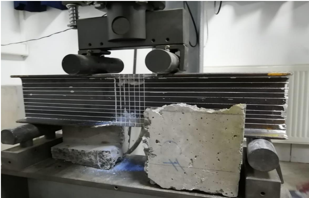
Ilustración 25 Probeta en prensa hidráulica para ensayo a flexión. [Elaboración propia].
