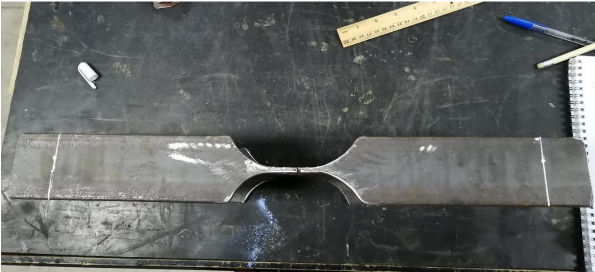
Ilustración 23 Trazado de posición de los apoyos en la probeta. [Elaboración propia].
