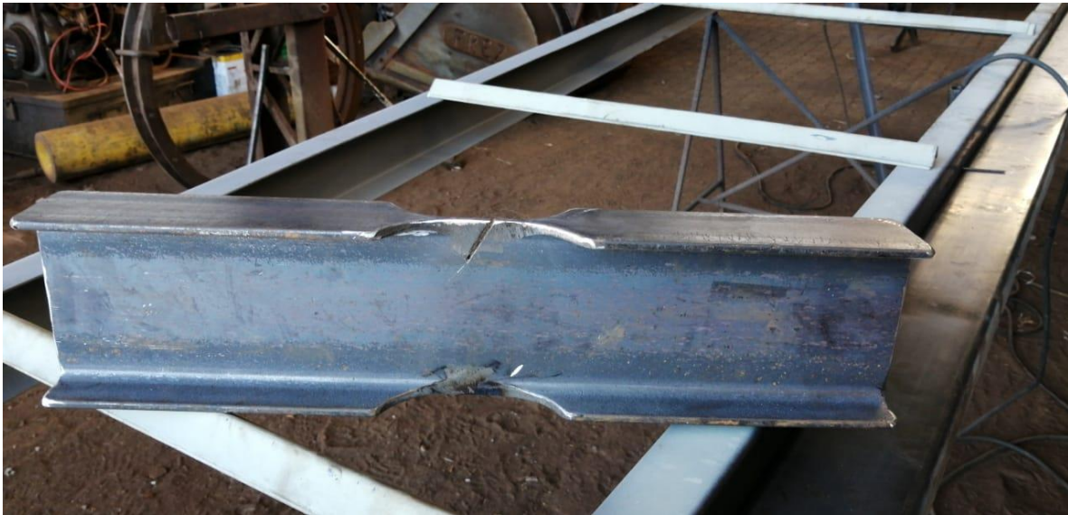
Ilustración 21 Viga dog-bone con grieta inducida. [Elaboración propia].
