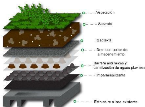
Ilustración. 2-2: Esquema cubiertas verdes
