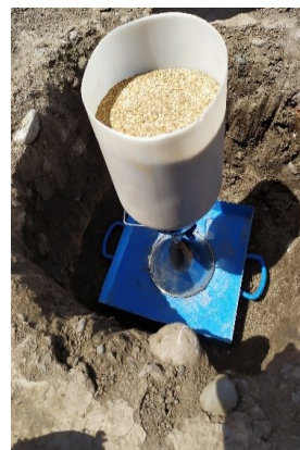
Figura 1. Equipo para ensayo de densidad In-situ
