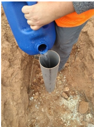
Figura 9: Prueba de infiltración directa en área circular. (PIDAC) Fuente: Elaboración propia
