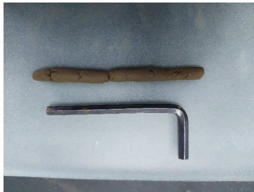
Figura 14: Para el límite plástico se hacen tiras de un diámetro de 3 mm Fuente: Elaboración propia
