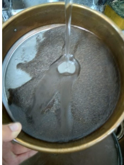
Figura 12: Lavado de muestra fina por el tamiz #200 Fuente: Elaboración propia
