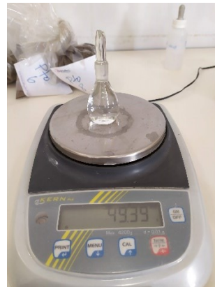
Figura 18: masa picnómetro + agua
