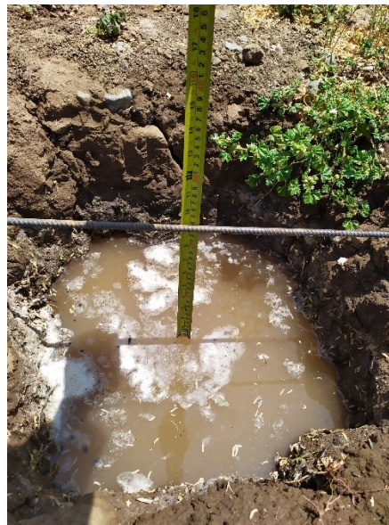
Figura 10: Ensayo Porchet Fuente: Elaboración propia
