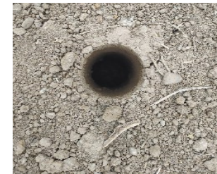
Figura 1. Perforación del ensayo Lefranc
