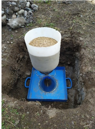
Figura 11: Aparato de densidad por cono de arena Fuente: Elaboración propia
