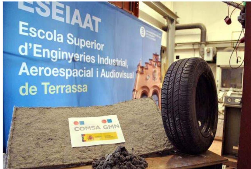
Figura 13: Panel aislante desarrollado con fibra textil reciclada de NFU Fuente: (COMSA, 2015)
