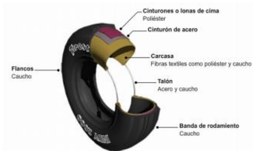
Figura 1: Partes de un neumático
