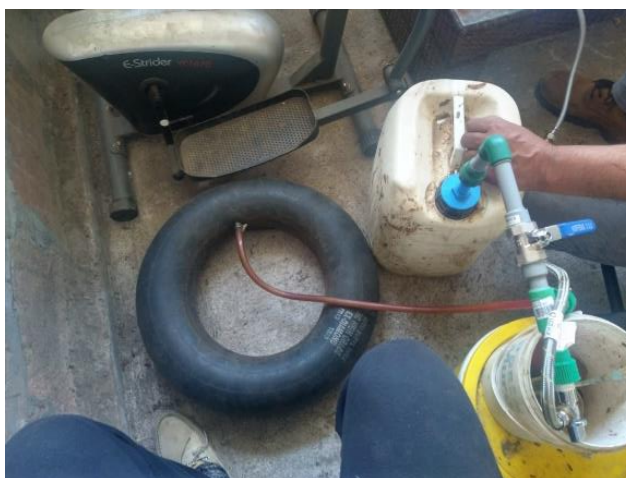
Ilustración 19: Biodigestor experimental luego de 3 semanas.
