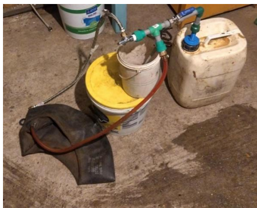
Ilustración 16: Biodigestor a escala recién construido e instalado.
