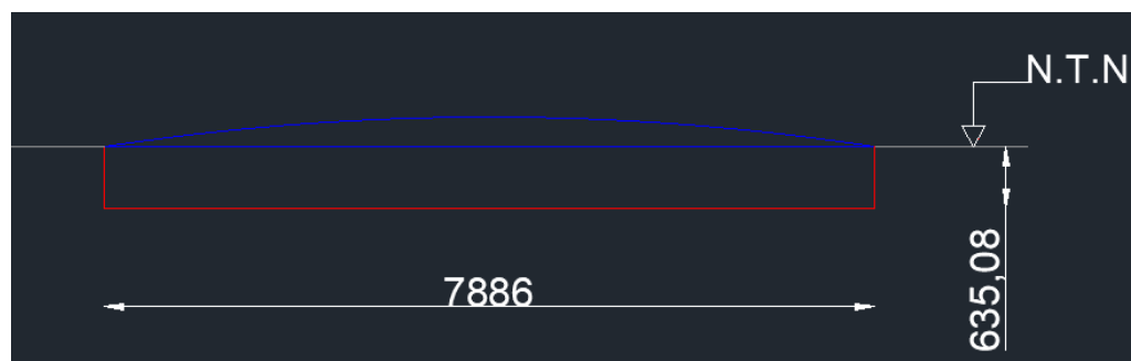
Ilustración 27: Elevación lateral biodigestor con cotas en milímetros.
