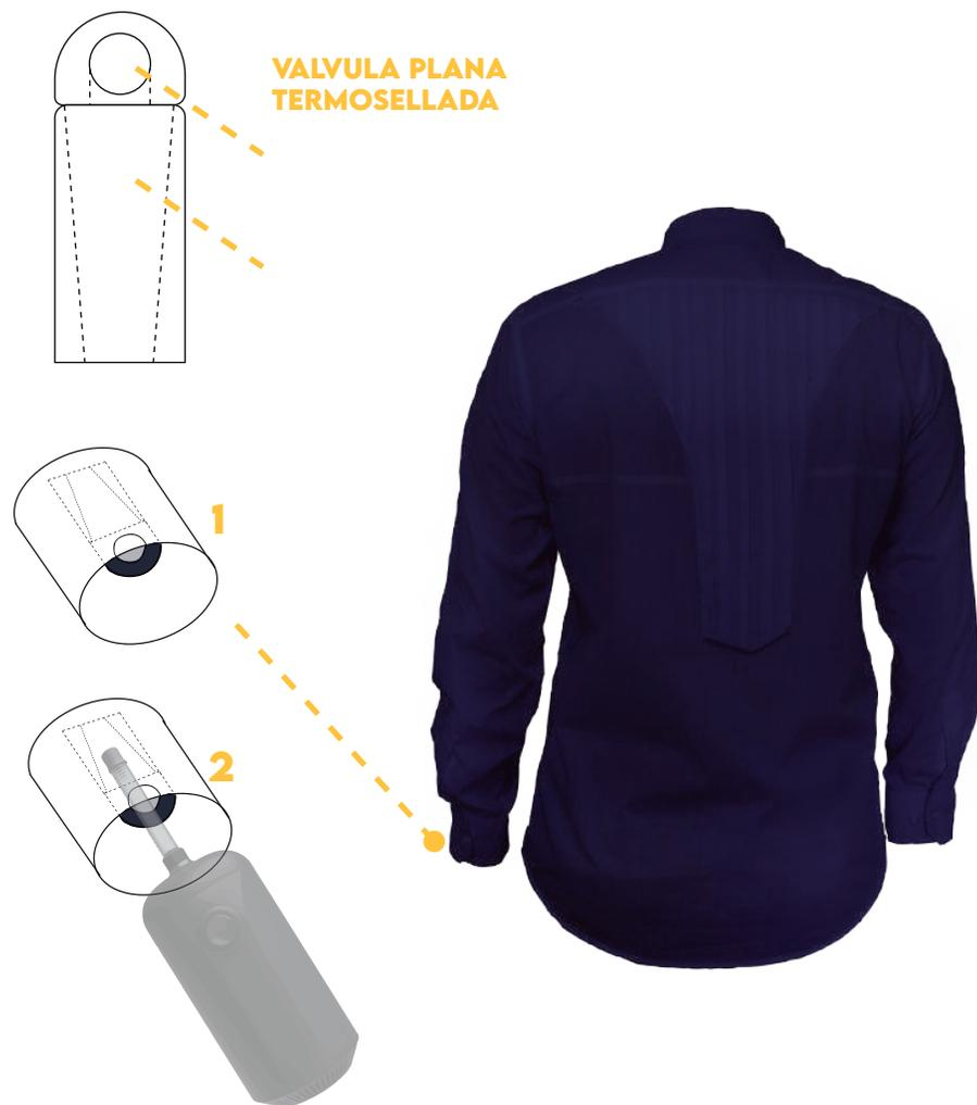
El sistema de valvula plana es el mismo utilizado en globos de helio o globos sellados. Esta valvula requiere ser termosellada y permite la entrada de la manguera para inflar. Una vez inflado, se retira la manguera y el aire no va a salir a menos que se vuelva a introducir la manguera y se active la bomba.
