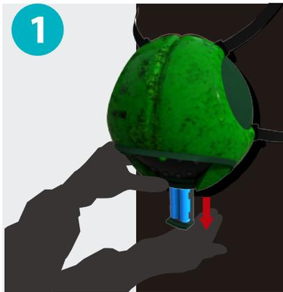
**1** Cada 6 meses o si le llega un mensaje al software de que un dispositivo tiene baja la batería, para cambiarlas, sólo debe presionar la zona inferior y el cartucho de baterías se desprenderá.
