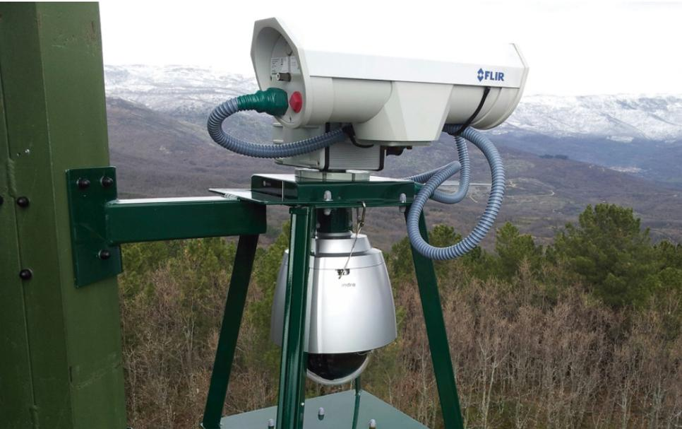
**con sistemas televisivos** Utilizan cámaras de televisión que transmiten su señal por microondas hasta las pantallas de un puesto de mando, por ejemplo en un vehículo en terreno, o hacia una Central de Coordinación
