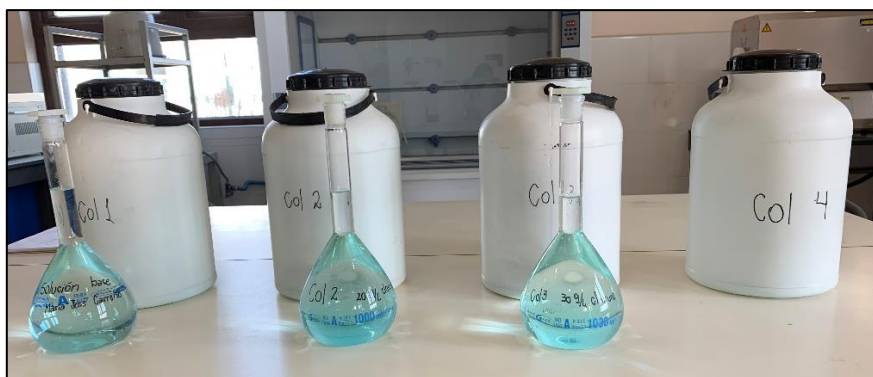
FIGURA 3.21. DISPOSICIÓN DE SOLUCIONES LIXIVIANTES EN TAMBORES.
