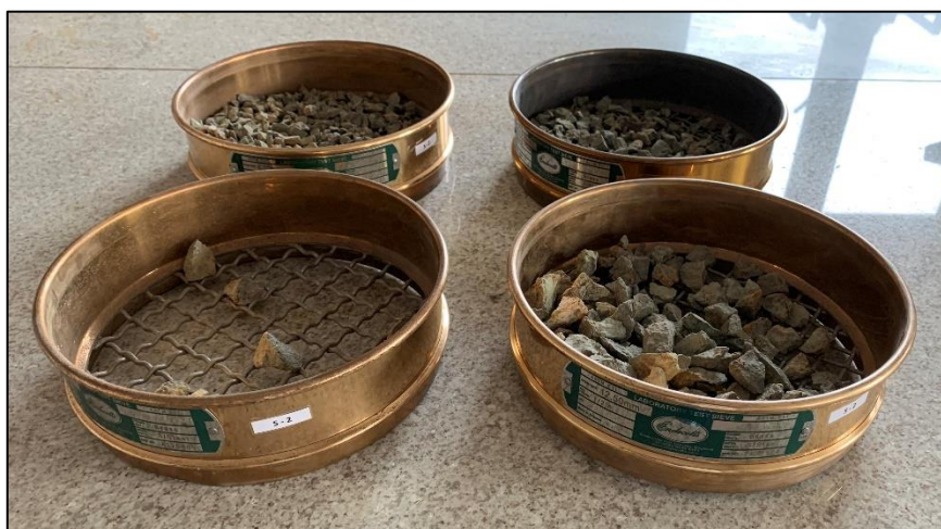
FIGURA 3.18. CLASIFICACIÓN DEL MINERAL OXIDADO EN LA SERIE DE TAMICES.
