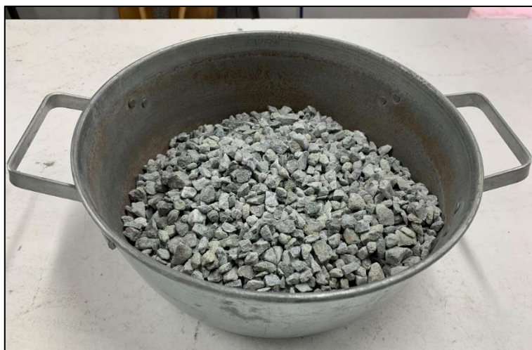
FIGURA 3.12. MINERAL DE SULFURO DE COBRE CON GRANULOMETRÍA DE \frac{3}{4} ".
