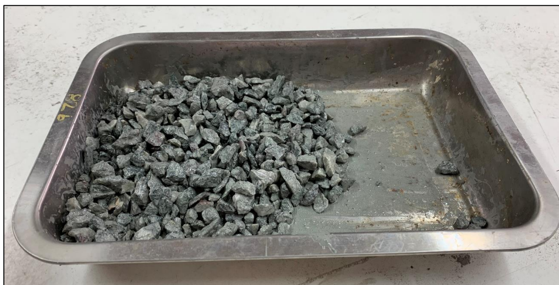
FIGURA 3.22. MINERAL AGLOMERADO DE SULFUROS QUE SERÁ DISPUESTO POSTERIORMENTE EN LAS COLUMNAS DE LIXIVIACIÓN.
