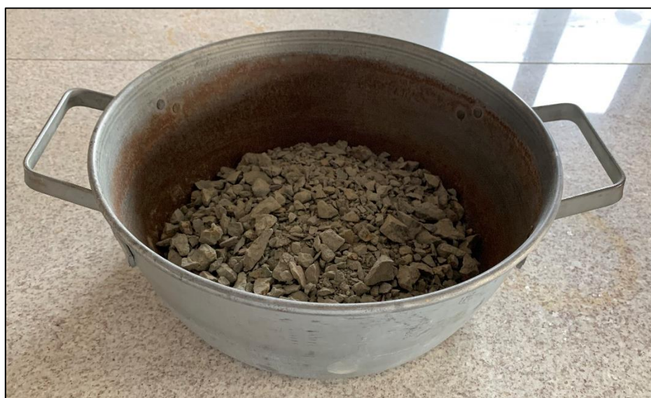
FIGURA 3.17. MINERAL DE ÓXIDOS DE COBRE CON GRANULOMETRÍA DE \frac{3}{4} " E INFERIOR.
