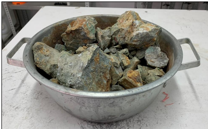
FIGURA 3.16. TAMAÑO INICIAL DEL MINERAL OXIDADO.
