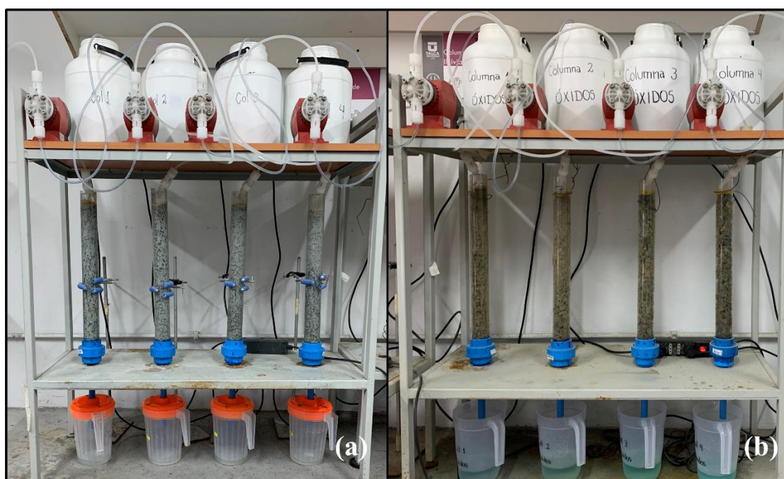
FIGURA 3.23. COLUMNAS DE LIXIVIACIÓN CON SOLUCIÓN DE REFINO EN (A) SULFUROS Y (B) ÓXIDOS.
