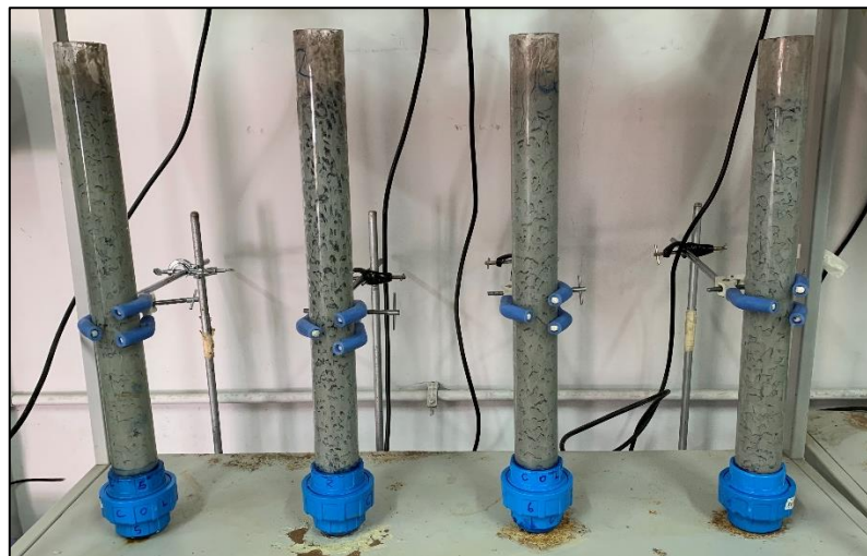
FIGURA 3.11. DISPOSICIÓN DE COLUMNAS DE LIXIVIACIÓN.
