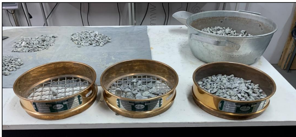
FIGURA 3.13. CLASIFICACIÓN DEL MINERAL SULFURADO EN LA SERIE DE TAMICES.
