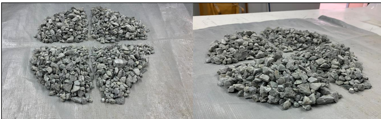
FIGURA 3.14. MUESTRA REPRESENTATIVA MEDIANTE LA TÉCNICA DE ROLEO Y CUARTEO.
