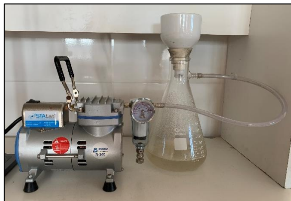
FIGURA 3.5. BOMBA DE VACÍO DE MEMBRANA (FILTRACIÓN DE PARTÍCULAS).
