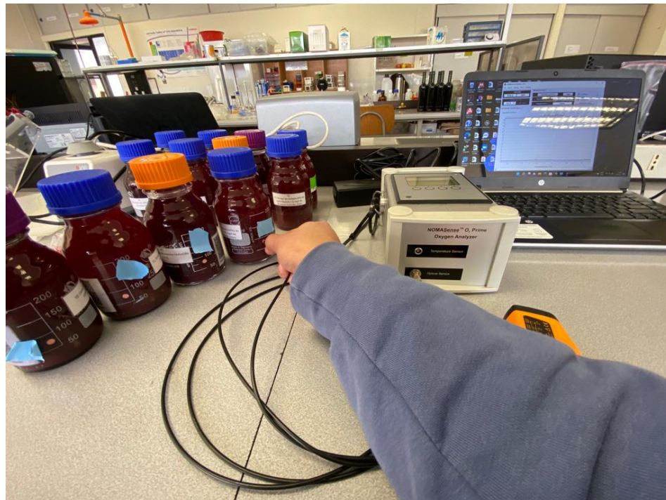
Figura 2. Medición de oxígeno disuelto con analizador NomaSense O 2 .
