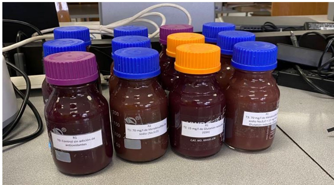
Figura 1. Botellas Schott con 300 mL de mosto de mosto cada una. Cada botella con su respectivo tratamiento, T0: sin antioxidantes; T1: con 70 mg/L de \text{Na}_2\text{S}_2\text{O}_5 ; T2: con 15 mg/L de GSH; T3: con 70 mg/L de \text{Na}_2\text{S}_2\text{O}_5 y 15 mg/L de GSH.
