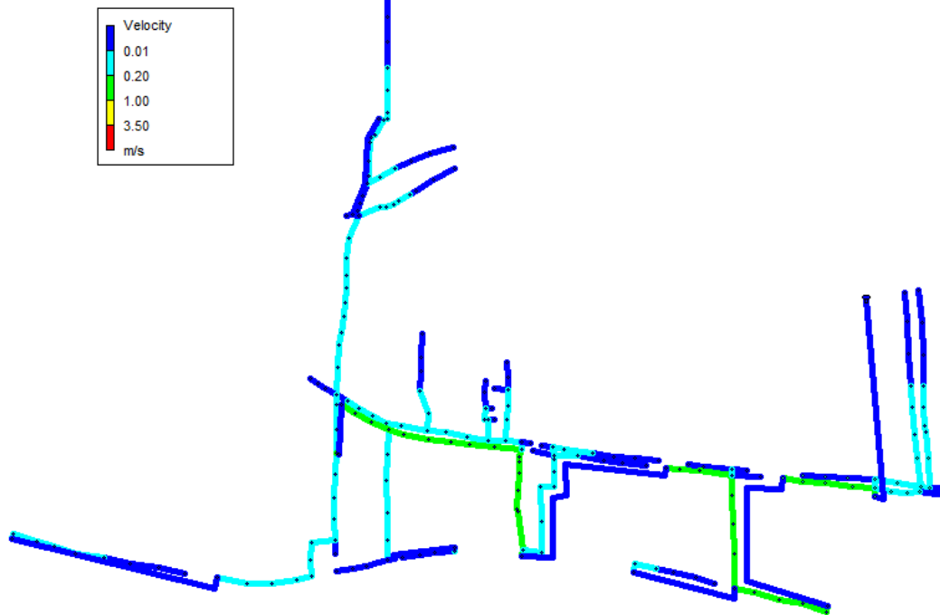
Ilustración 20: Red con tuberías de 200mm
