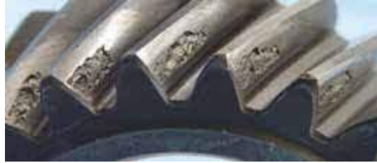
Figura 2.9. Fractura por picaduras. Fuente: [26].
