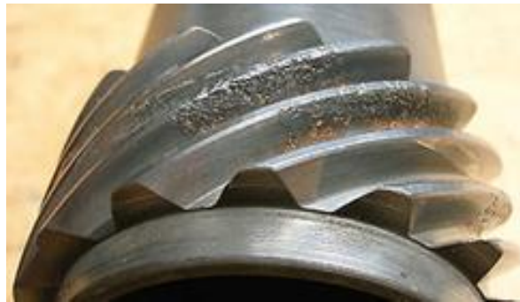
Figura 2.7. Desgaste corrosivo engranaje. Fuente: [25].
