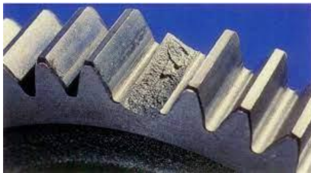
Figura 2.10. Desprendimiento de diente por sobretensión. Fuente: [26].
