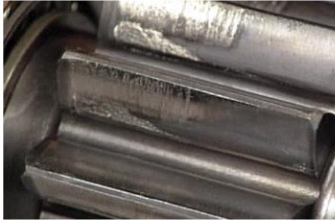
Figura 2.6. Desgaste abrasivo en engranaje. Fuente: [25].
