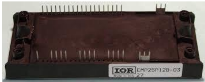
Fig. 2.14 Módulo integrado de potencia EMP25P12B
