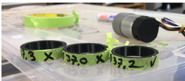
Fig. 3.5.1.6: Prueba de holgura para encaje.
