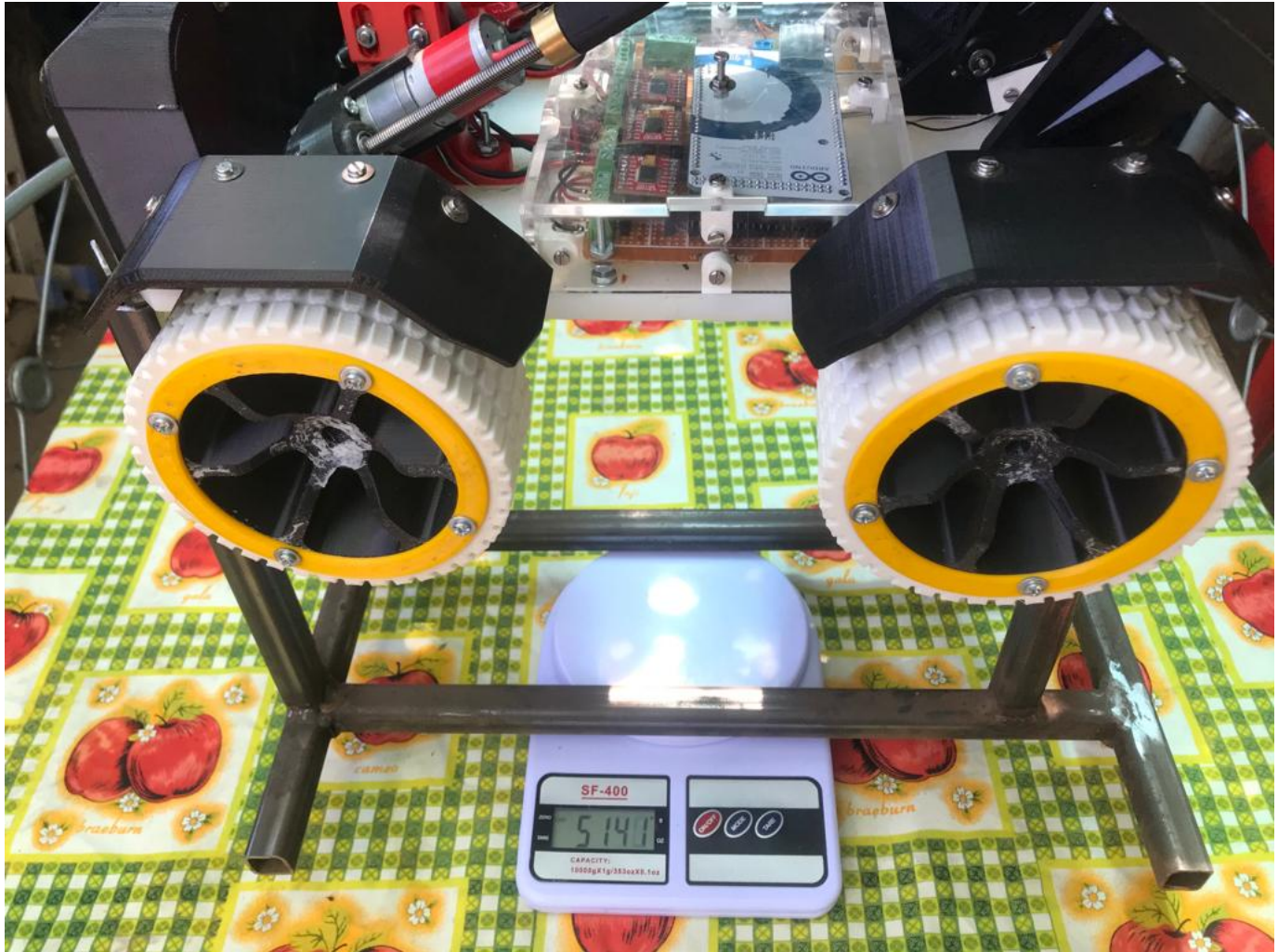
Fig. 5.2.0.1: Proceso de pesaje prototipo final.
