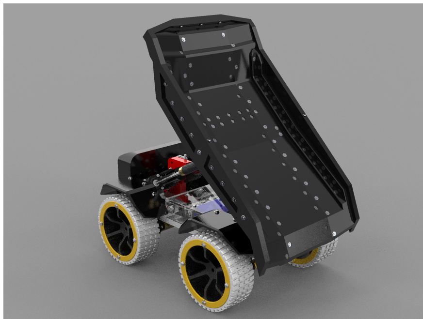
Fig. 3.2.1.4: Tolva en el conjunto camión.
