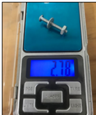
Fig. 3.3.2.3: Pesaje experimental, perno de ensamble
