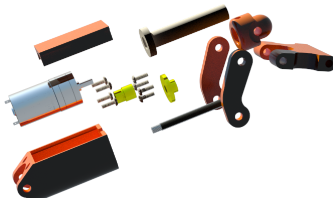
Fig. 2.8.0.2: Empleo de motores DC en mecanismos "pala".
