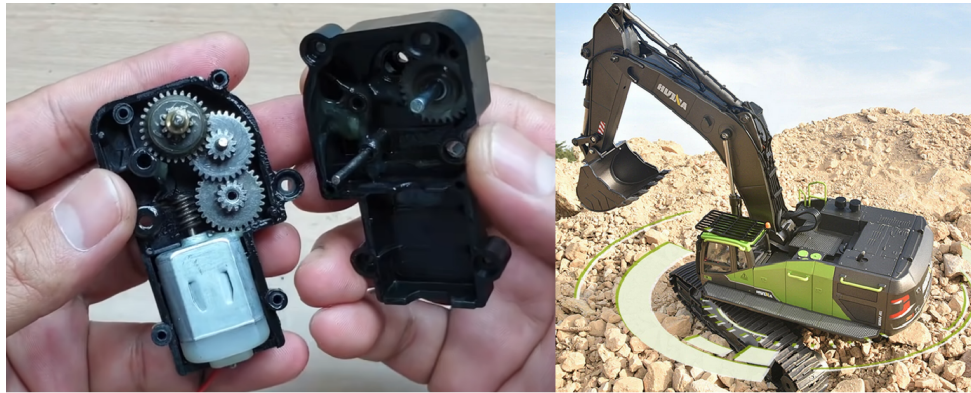
Fig. 1.2.4.7: Mecanismo interno Huina 593 1:14 RC.
