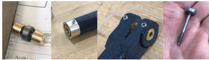
Fig. 3.5.3.2: Piezas mecanizadas en torno.
