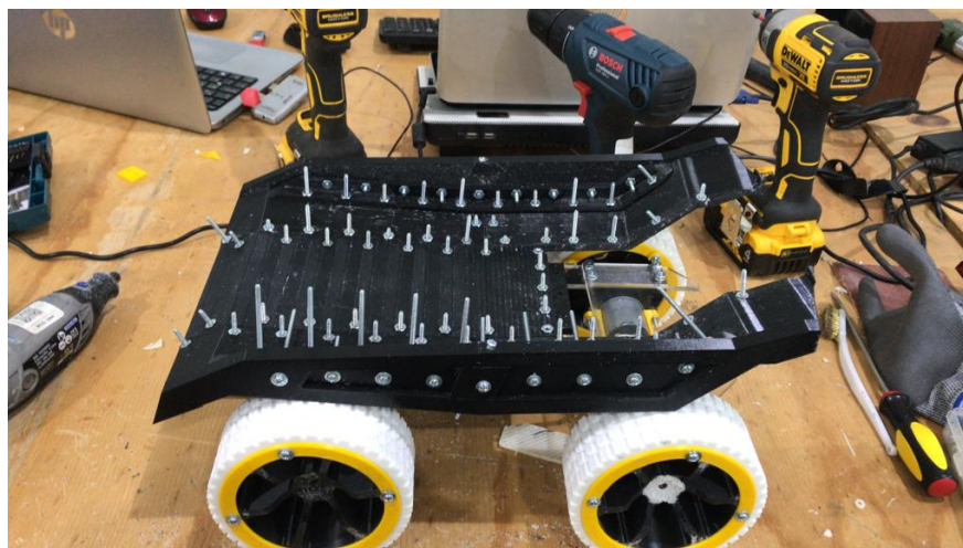
Fig. 3.5.4.2: Ensamble de tolva mediante el uso de pernos.
