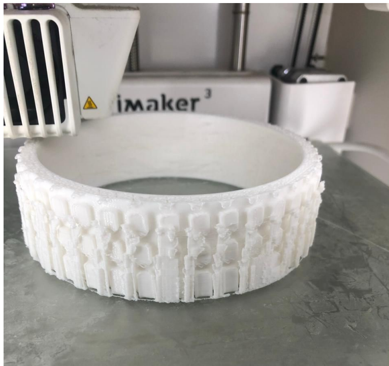
Fig. 3.5.1.4: Resultado impresión Neumático en Ultimaker 3
